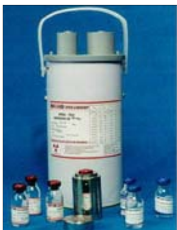
FIGURA 6.5- Gerador de tecnécio
