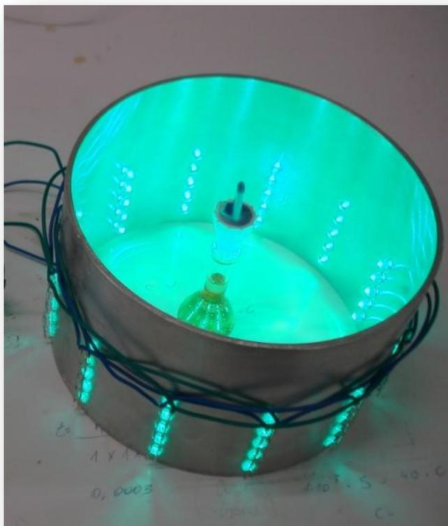
Figura 4.4 – Fotoisomerização do composto *trans*-[RuCl<sub>2</sub>(dppb)(bipy)] irradiado no reator fotoquímico a LEDs (540 nm).
