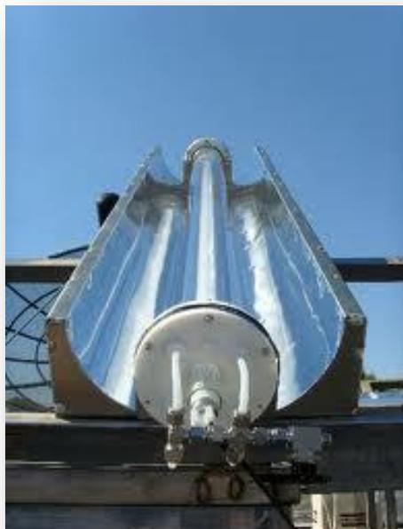
Figura 2.14 – Reator fotoquímico solar (Fonte: <http://www.psa.es/webesp>, 2010)
