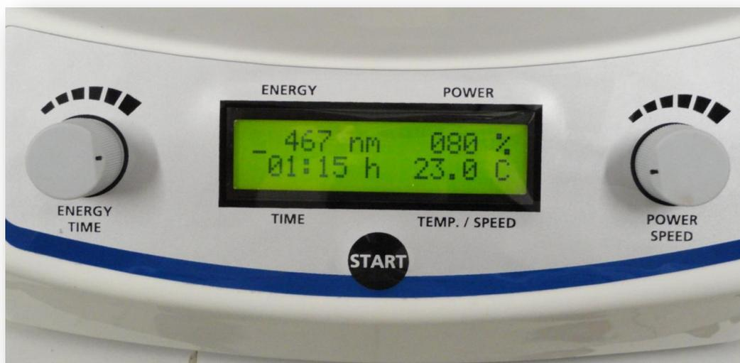
Figura 3.16 – Interface para entrada de dados do reator fotoquímico a LEDs
