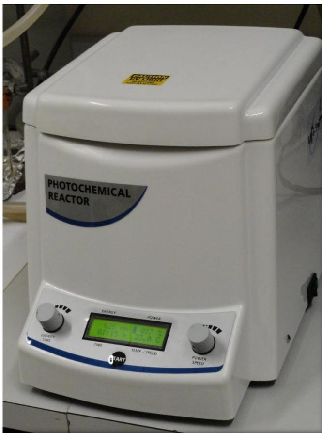
Figura 5.3 – Protótipo do reator fotoquímica a *LED*.
