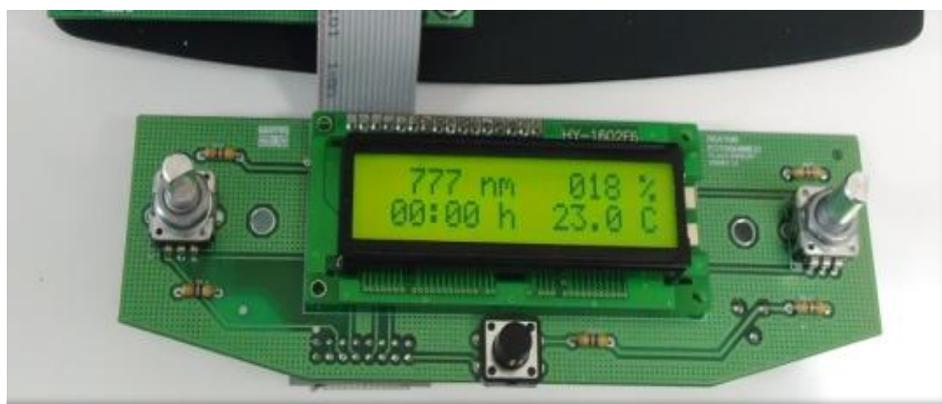
Figura 3.27 – Acomodação dos componentes eletrônicos na placa de interface com usuário do reator a LEDs
