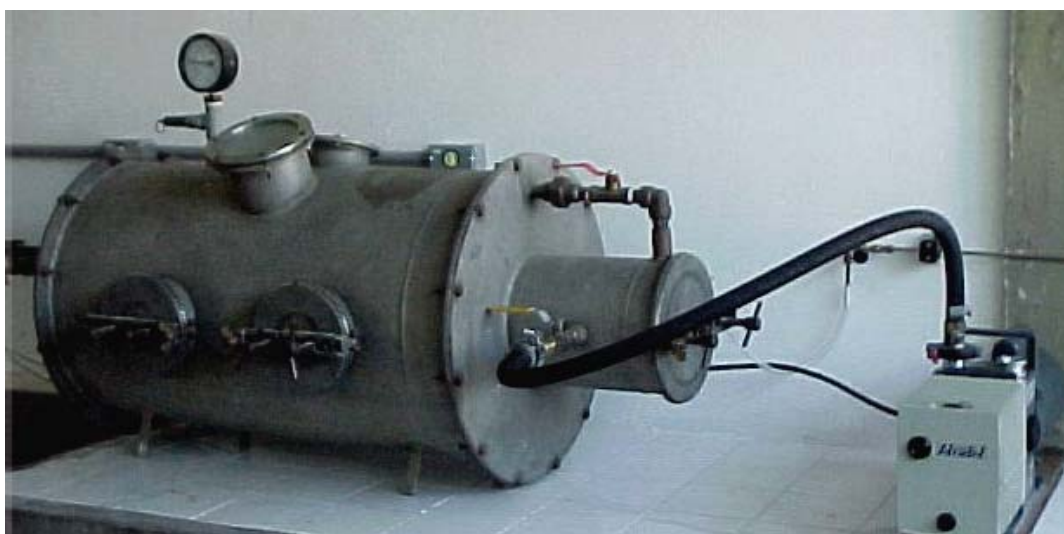
Figura 3.1 - Imagem da Glove-box utilizada para manipulação de amostras.
