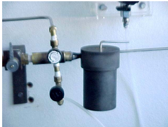
Figura 3.6 - Sistema para evacuar / injetar gás na cuba.
