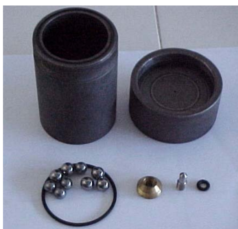
Figura 3.4 - Cubas utilizadas no moinho P6, bolas de moagem e válvula agulha.
