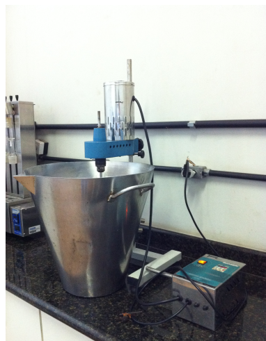
Figura 6.1 Sistema utilizado no aumento de escala para produção da borra protegida.
