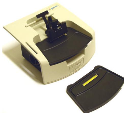
FIGURA 5.2. Sistema de ATR para coleta do espectro de infravermelho utilizado neste estudo (Thermo Nicolet Nexus).
