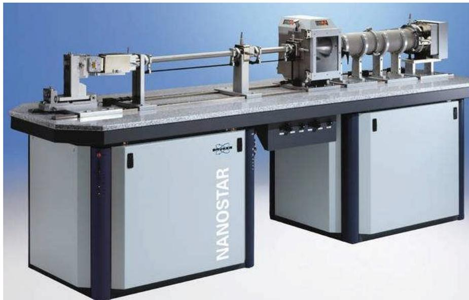
FIGURA 6.9. Foto ilustrativa do equipamento NanoSTAR SAXS SYSTEM utilizado neste estudo.
