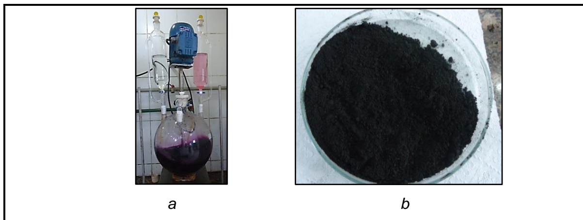
FIGURA 32: Sistema reacional para preparação do dióxido de manganês(IV).
