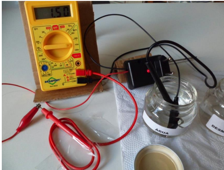
FIGURA 2.8 – Medição de corrente elétrica em água potável com um multímetro conectado em série com o indicador de condutividade elétrica.
