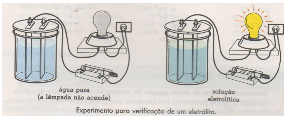
FIGURA 1.1 – Reprodução de montagem para verificação de condutividade apresentada no livro-texto de NEHMI (1994, p. 161).
