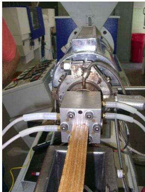
Figura 4.44 – Perfil em processo de extrusão
