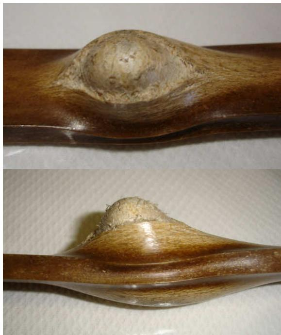
Figura 4.46 – Aspectos do perfil extrudado com rompimento na superfície
