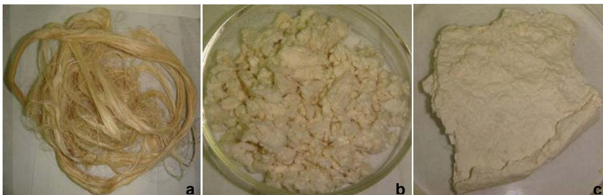
**Figura 6.1:** Fibras de curauá (a) formato original, (b) moída e (c) após mercerização com solução de NaOH 5%
