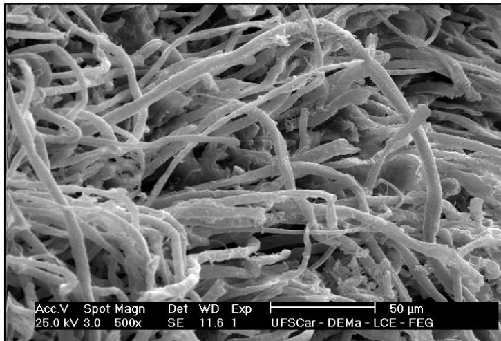
**Figura 6.31:** Micrografia por MEV do compósito de EVA + 30F
