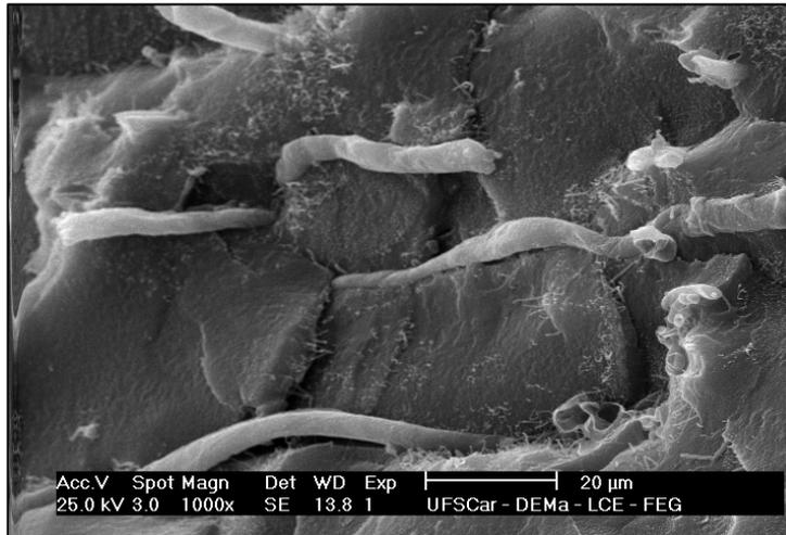
**Figura 6.27:** Micrografia por MEV do compósito de EVA + 5F
