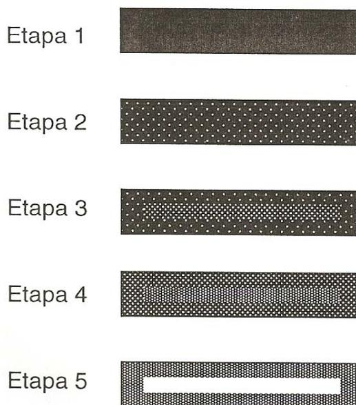
**Figura 2.7 – Ilustração esquemática da progressão do processo de hidrólise [92]**
