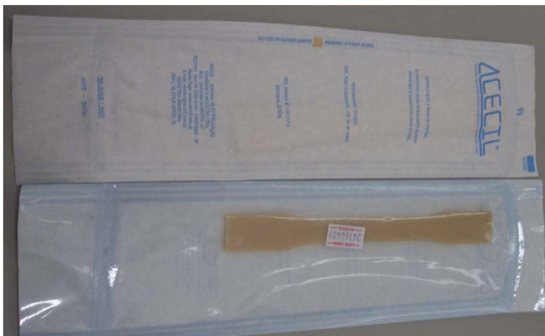
Figura 3.2 – Corpo de prova esterilizado e embalado
