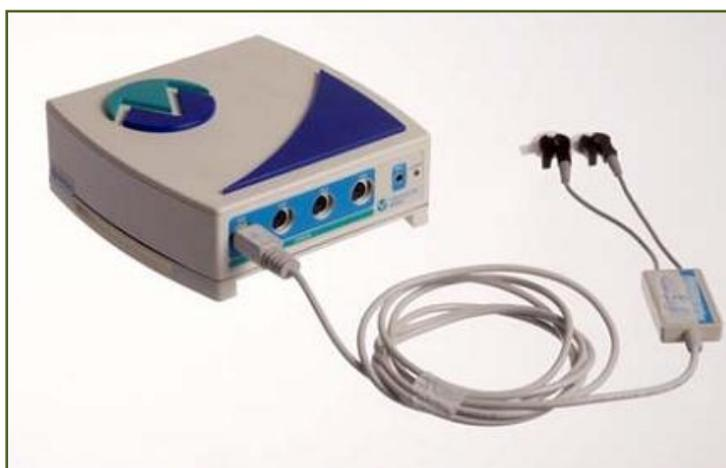
Figura 4: Eletromiógrafo Miotool 400
