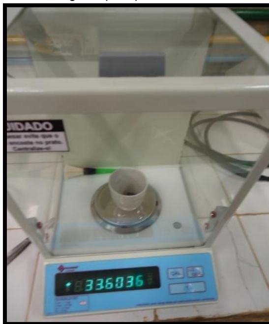
Fotografia 9 - Pesagem após queima em mufla e dessecação
