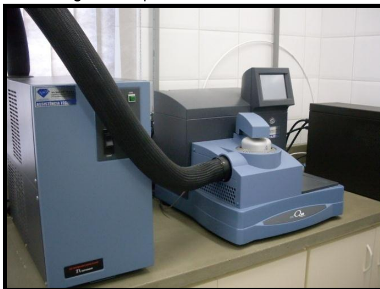
Fotografia 4 - Aparelho de calorimetria DSC Q100
