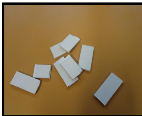
Fotografia 2 - Corpos de prova de PVC para ensaio de Temperatura de Amolecimento de Vicat
