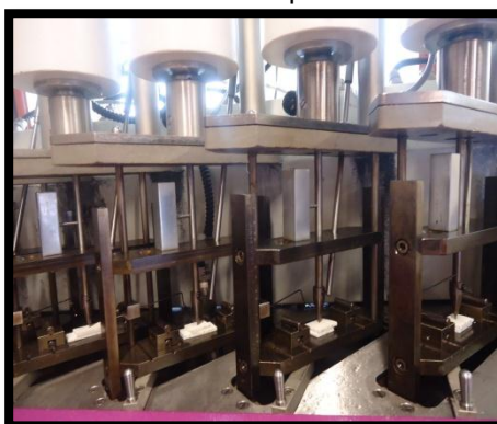
Fotografia 3 - Equipamento de ensaio de Temperatura de Amolecimento de Vicat
