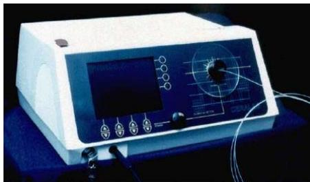
**Figura 10: Fonte de luz utilizada para a TFD. Laser de Diodo em 630 nm utilizado para excitação das porfirinas e derivados de hematoporfirinas.**
