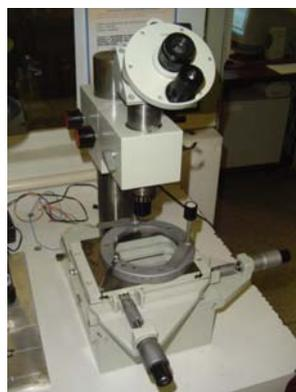
**Figura 11: Microscópio (com os micromanipuladores acoplados) utilizado na pesquisa.**
