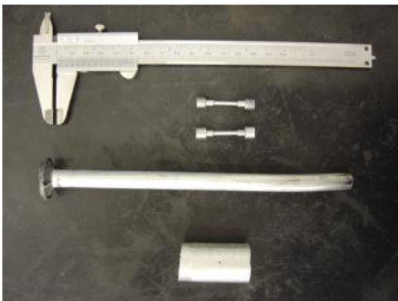
Figura 4.3.1 – Cilindro usinado a partir do depósito, vareta extrudada e corpos de prova de tração.
