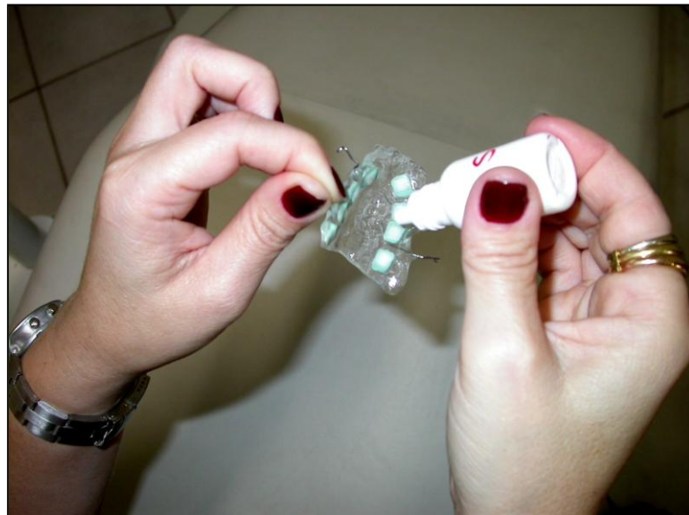
Figura 7 – Gotejamento com solução aquosa de sacarose a 2% sobre cada bloco de esmalte bovino
