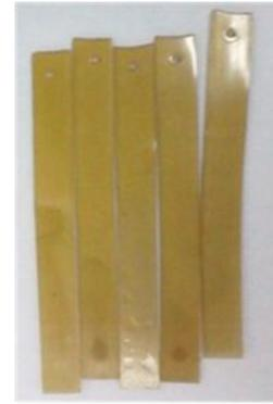
7C. Ilustração do corpo de prova para biodegradação (retangular)
