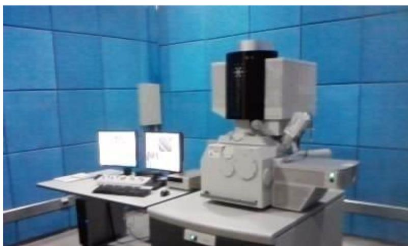
Figura 17 . Microscópio eletrônico de varredura
