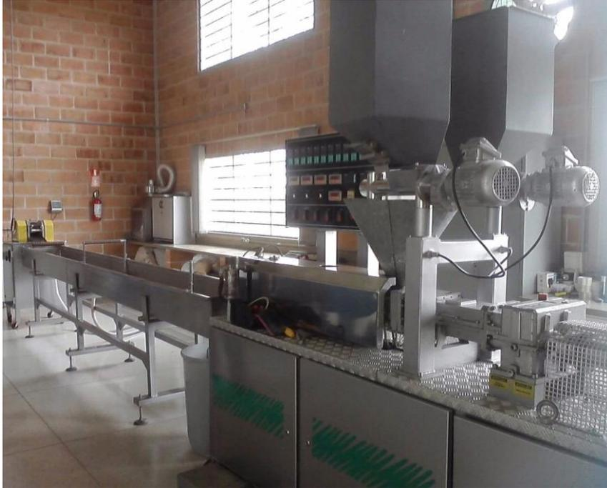
Figura 5. Extrusora IMACOM modelo DRC 30:40, dupla rosca, utilizada para a preparação do composto.
