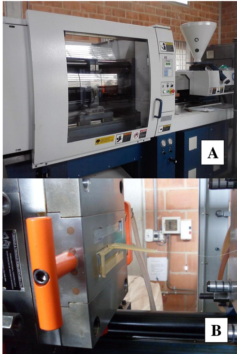
Figura 6. A: Injetora: ROMI® Prática 130 utilizada para a confecção dos corpos de prova. B: PLA com nanopartícula de prata sendo injetado.
