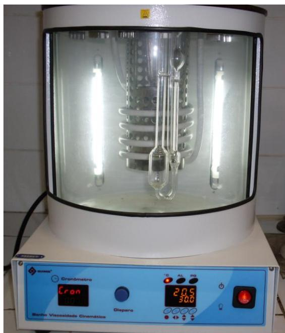
Figura 14. Viscosímetro e Banho Térmico empregados no experimento de Viscosidade de Soluções Diluídas
