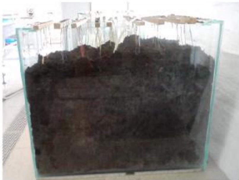
Figura 13. Corpos de prova enterrados no solo.
