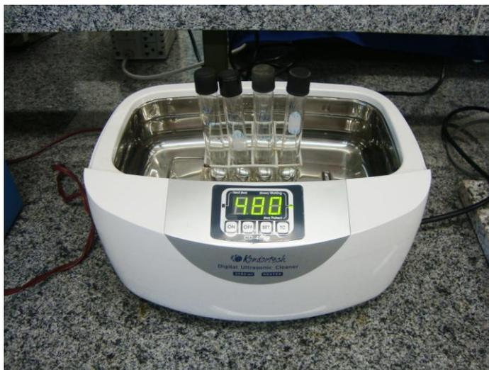
Figura 11. Cuba de ultrassom (Digital Ultrasonic Cleaner) usada para provocar a desagregação do biofilme bacteriano aderido aos corpos de prova.
