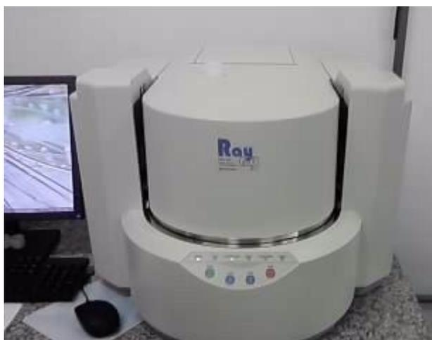
Figura 15. Fluorescência de raios x através do Aparelho Rayny EDX- 720, produzido por Shimadzu.
