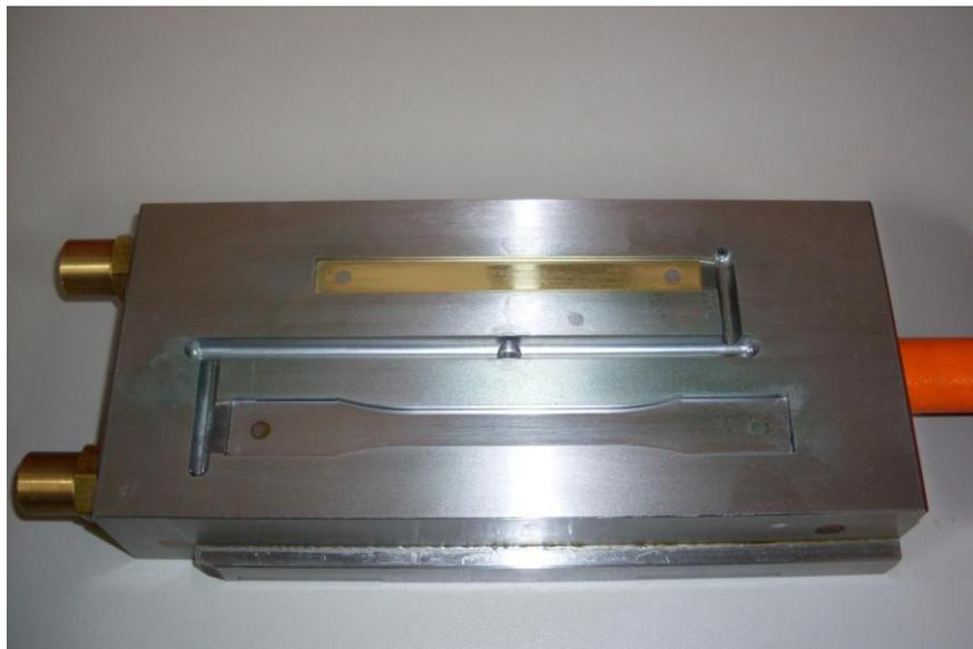
Figura 8. Molde da Injetora com a “régua” para confecção dos corpos de prova retangulares.
