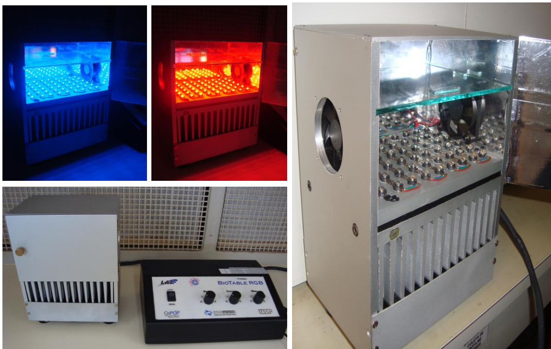
Figura 9. Detalhes da BioTable ® , mesa iluminadora desenvolvida por pesquisadores da USP – IFSC (ARANTES, 2010).
