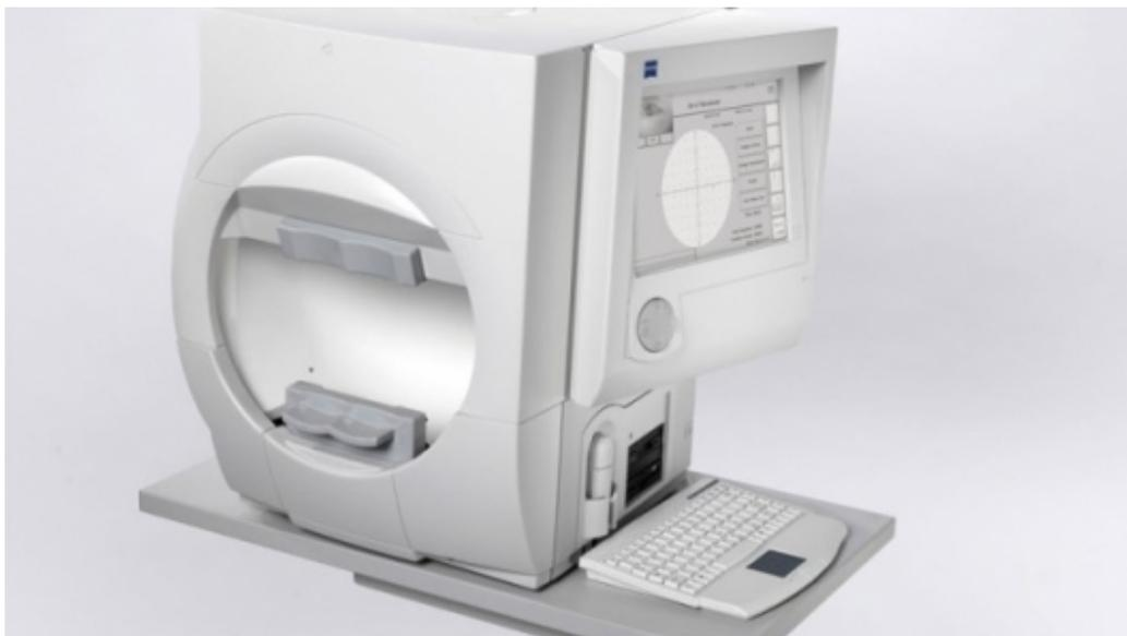
**Figura 3. Campímetro considerado “Padrão Ouro” pela comunidade oftálmica, importado da Alemanha. O instrumento contém uma tela de projeção esférica baseada no princípio de Goldmann, um computador embutido e um monitor monocromático para visualização dos dados.**
