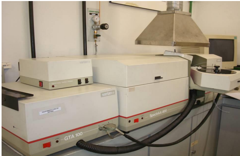
Figura 17. Espectrômetro de absorção atômica em forno de grafite (GFAAS) utilizado na determinação das concentrações de As total na água de cultivo, no sobrenadante do sedimento e nos organismos-teste
