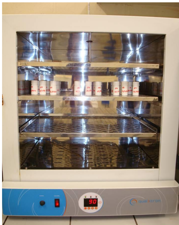
Figura 19. Estufa a 90 °C por 48 h para digestão ácida dos organismos em frascos de policarbonato
