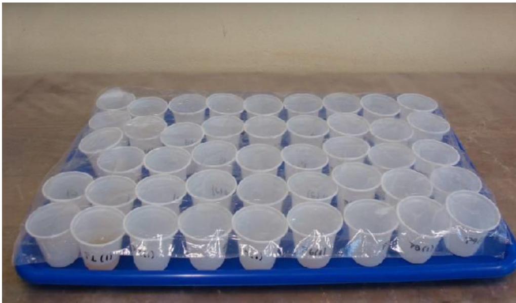
Figura 15. Recipientes plásticos de poliestireno atóxicos contendo 10 mL de solução teste, utilizados nos testes de toxicidade aguda com o cladócero C. silvestrii
