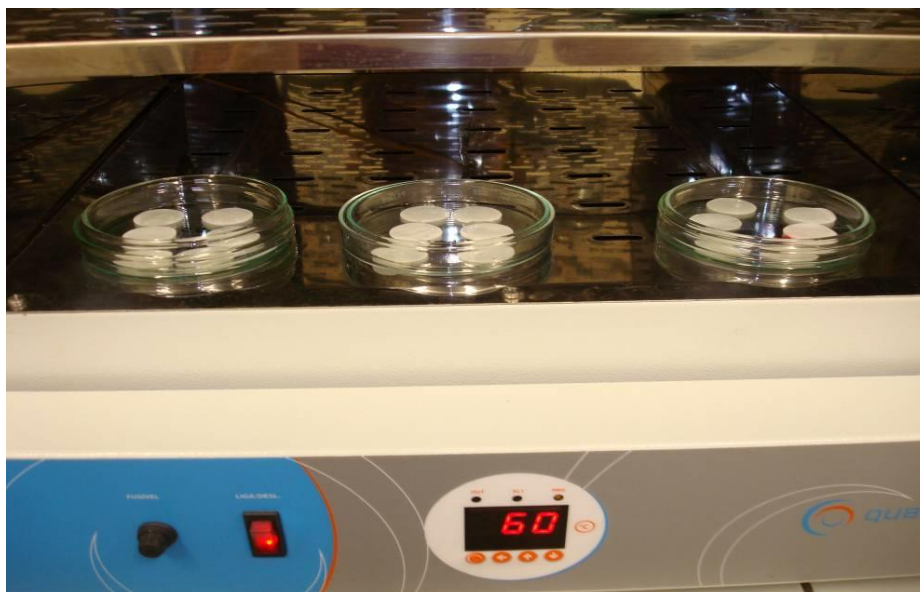
Figura 18. Estufa a 60 °C por 48 h para secagem das membranas contendo os organismos
