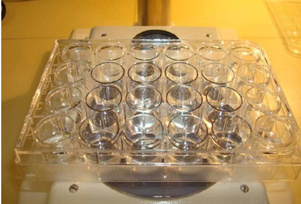
Figura 14. Microplaca de cultivo com 24 poços, destinada aos testes de toxicidade com o protozoário P. caudatum
