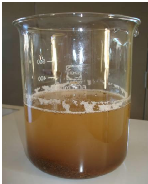
Figura 13. Béquer contendo a amostra de sedimento em processo de sedimentação, na proporção de 4:1 (peso) de água de cultivo dos organismos e sedimentos, respectivamente
