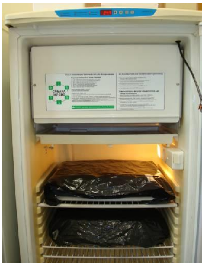
Figura 16. Incubadora utilizada para o experimento de toxicidade aguda com o cladóceros C. silvestrii
