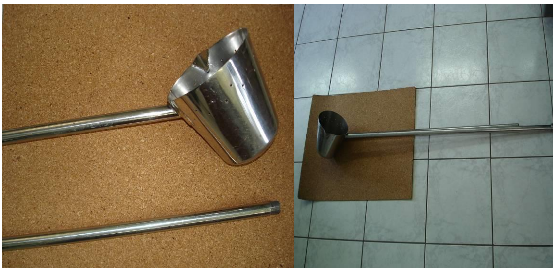
Figura 8. Coletor de sedimento utilizado nas coletas (Foto: Cleber Valim Alexandre)
