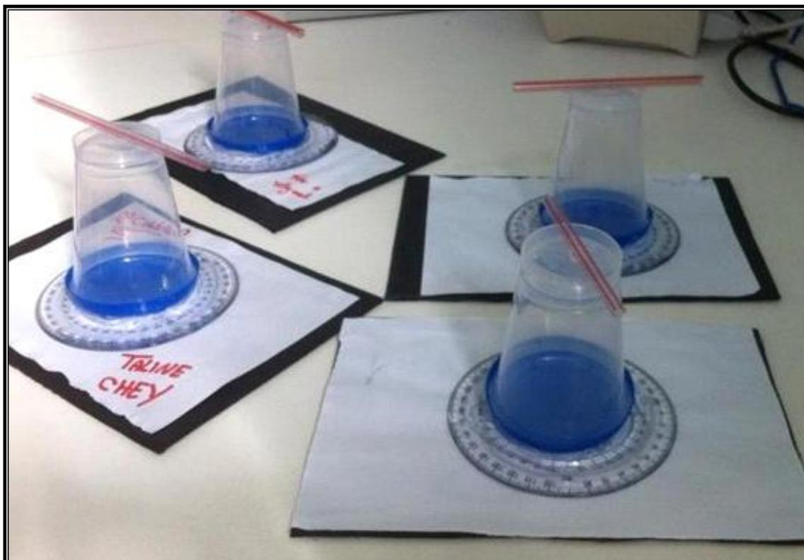
Foto 1 – Teodolitos construídos pelos alunos
