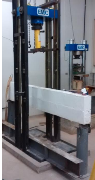
Figura 39 - Posicionamento da Viga
