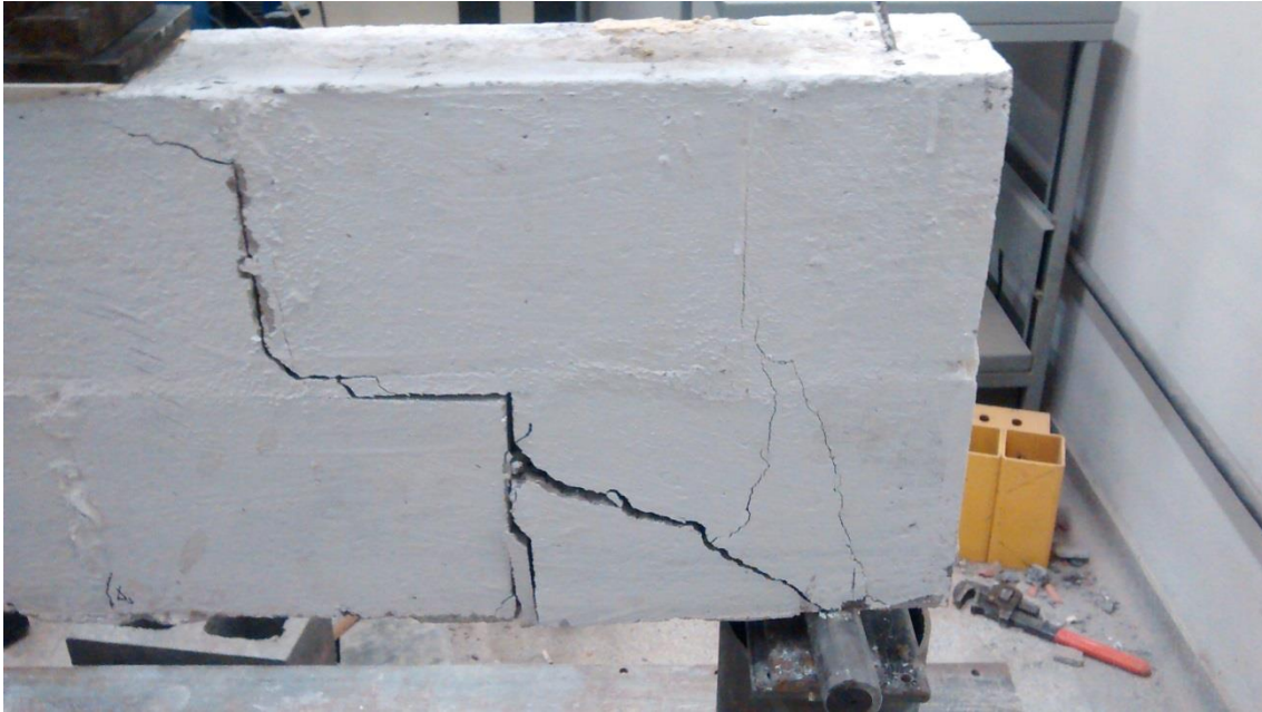
Figura 65 – Ruptura por Cisalhamento
