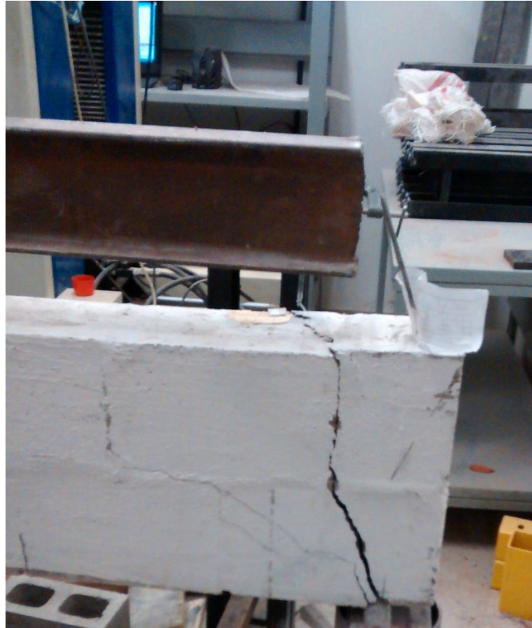
Figura 53 - Ruptura Viga V15B
