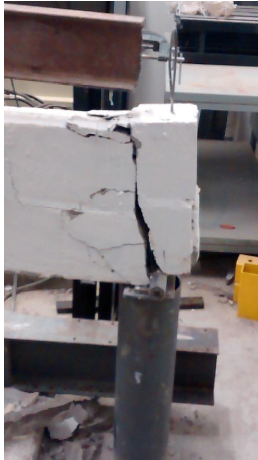
Figura 71 - Ruptura Viga V16A
