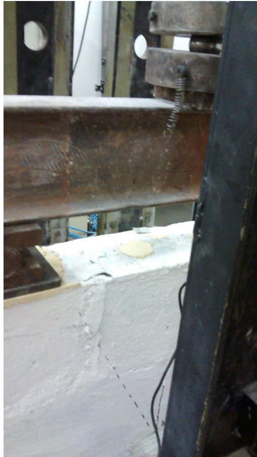
Figura 52 - Destacamento na Região próxima da Carga
