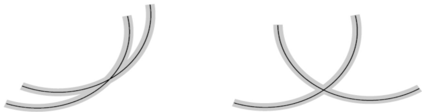
Figura 12: Um pequeno ângulo de intersecção na parte esquerda (a perda de precisão) e um grande ângulo para a direita .
