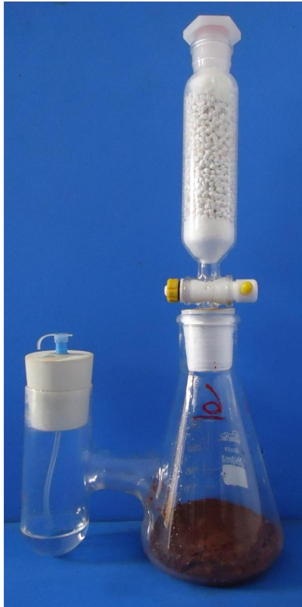
**Figura A.1** Sistema (Bartha) utilizado nos processos de biodegradação dos filmes de PEAD e celulose microcristalina.
