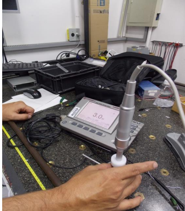
Figura 12 - Medida de potência com a caneta encostada no sensor
