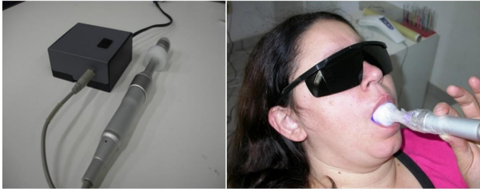
Figura 7 - Imagem da difusora de luz azul com 5 leds emitindo em 450nm de comprimento de onda.
