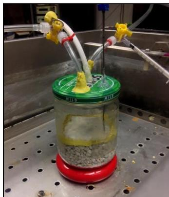
**Figura 5:** Câmara pletoimográfica, feita a partir de um recipiente de condimento, para camundongos inserida em aparelho de banho.
