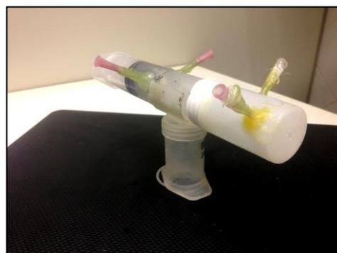
**Figura 3.** A. Disposição do método de plethysmografia de pressão utilizada para neonatos de mamíferos (adaptado de Mortola e Frappel, 2013), que mostra a câmara do corpo e cabeça. P – pressão; T – temperatura no interior da câmara; F – medidor de fluxo de entrada de ar; F - S – entrada e saída de ar. B. Câmara do corpo para medidas de plethysmografia de pressão e câmara da cabeça para passagem de gases e medidas de consumo de oxigênio, utilizadas no experimento.
