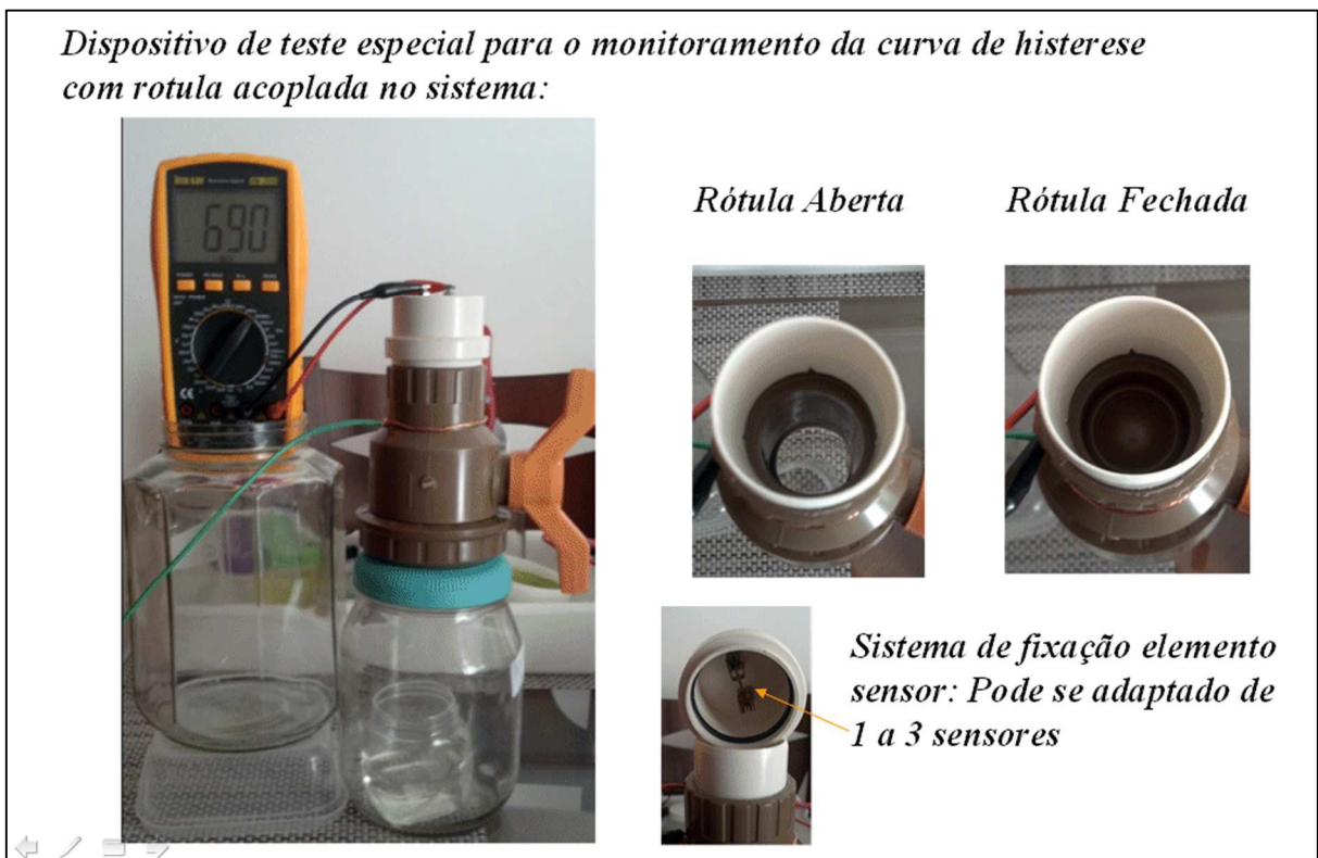
Figura 63: Dispositivo especial com rótulas de abre e fecha para avaliação de histerese.
