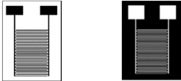
Figura 24: Lado esquerdo – Figura de um sensor interdigitado convencional e lado direito – Novo sensor em desenvolvimento com as fibras de celulose dopado na região branca.
