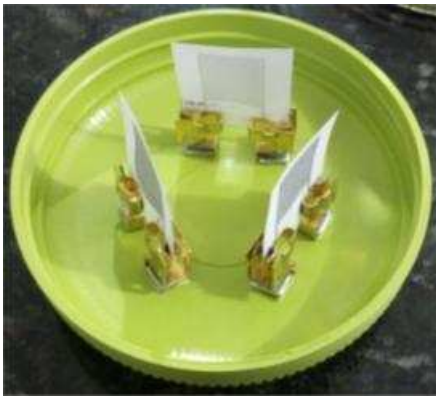
Figura 35: Montagem em ligação série ou paralelo dos três sensores discretos de estados sólidos, acoplados ao reservatório do nariz eletrônico portátil junto com o diagrama elétrico de uma ligação-série e ligação paralelo.
