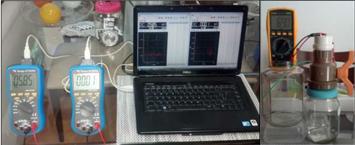
Figura 33: Equipamento nariz eletrônico portátil, construído durante o desenvolvimento do sensor, formado basicamente por um multímetro com interface USB, um notebook e um reservatório de vidro com um sistema valvulado.
