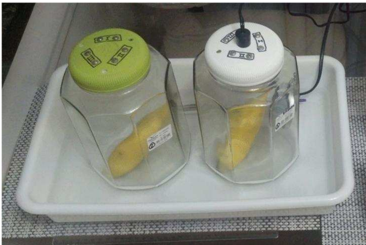
Figura 66: Sistema banho-maria com controlador de temperatura automática até 35°C. Dispositivo para compensar a variação da temperatura ambiente (verão e inverno) fora do laboratório.
