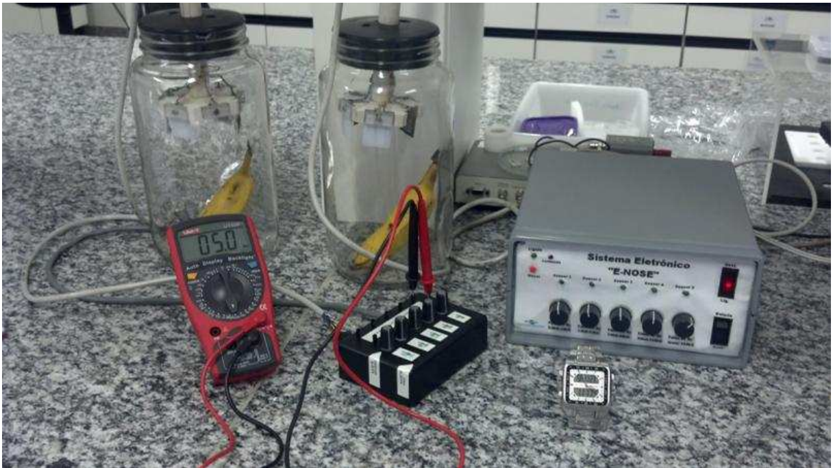
Figura 39: Utilizado o mesmo aparato de teste do e-Nose, com quatro canais com tira de papel sulfite. Coletado o sinal de resistência, via multímetro, antes do módulo coletor de dados com o e-Nose desligado. Montagem: aquisição de dados, via pontas de prova, do multímetro no módulo (caixa preta) do e-Nose.
