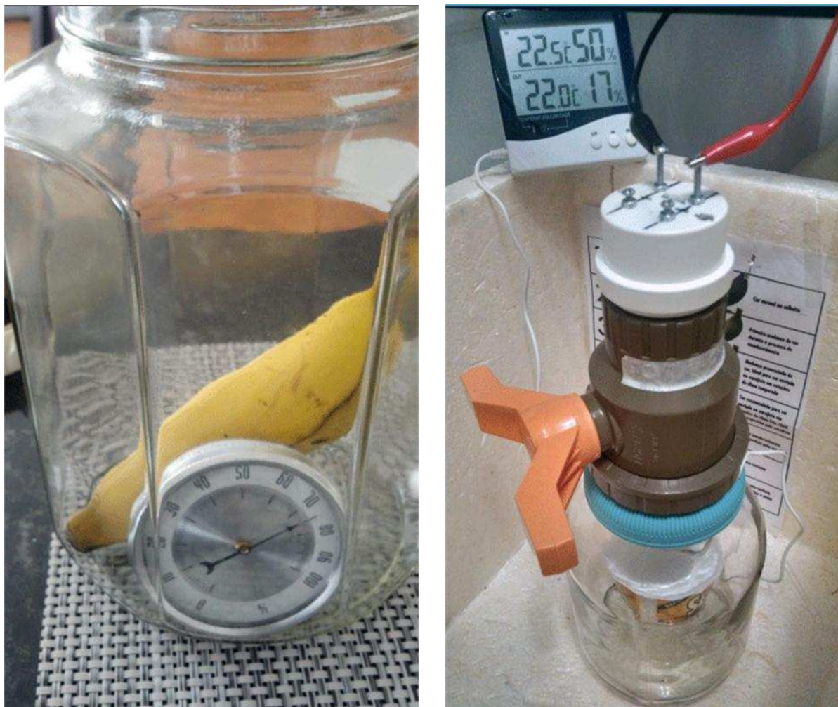
Figura 71: Dispositivos para avaliação da umidade dentro do reservatório. (A) analógico e (B) digital, que medem simultaneamente a umidade interna e externa do reservatório.
