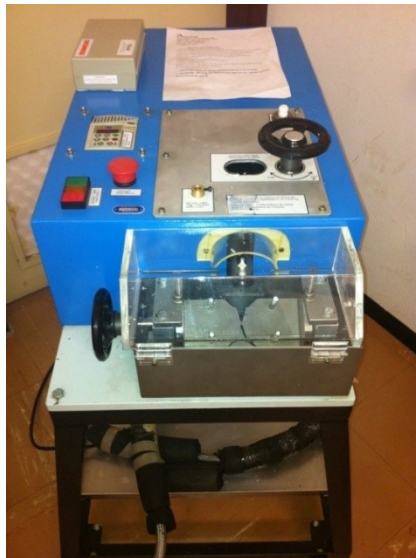
Figura 3.2 - Entalhadeira para usinagem de CPs de EWF do tipo DDENT.
