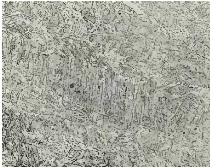
Figura 3.16 Imagem de microscopia ótica do metal de solda usando 0,74 kJ/mm – Martensita (500X) [22]
