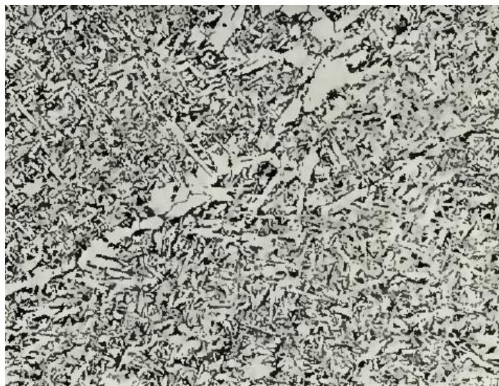
Figura 3.18 Imagem de microscopia ótica do metal de solda usando 10 kJ/mm – Ferrita Acicular (500X) [22]
