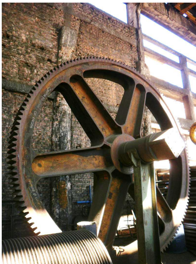
Figura 3.3 Engrenagem com quase 4,0m de diâmetro, da Usina Santa Helena, em Rio das Pedras/SP (foto tirada pelo autor).
