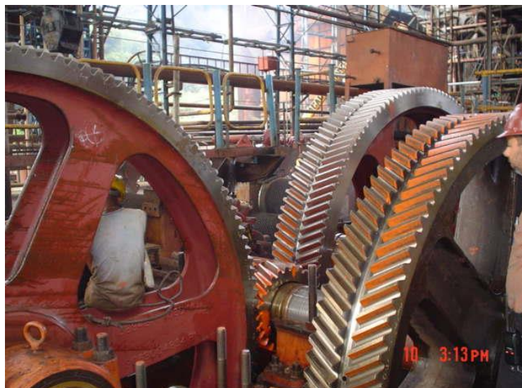
Figura 3.2 Conjunto de engrenagens montadas em moenda de cana (foto tirada pelo autor)
