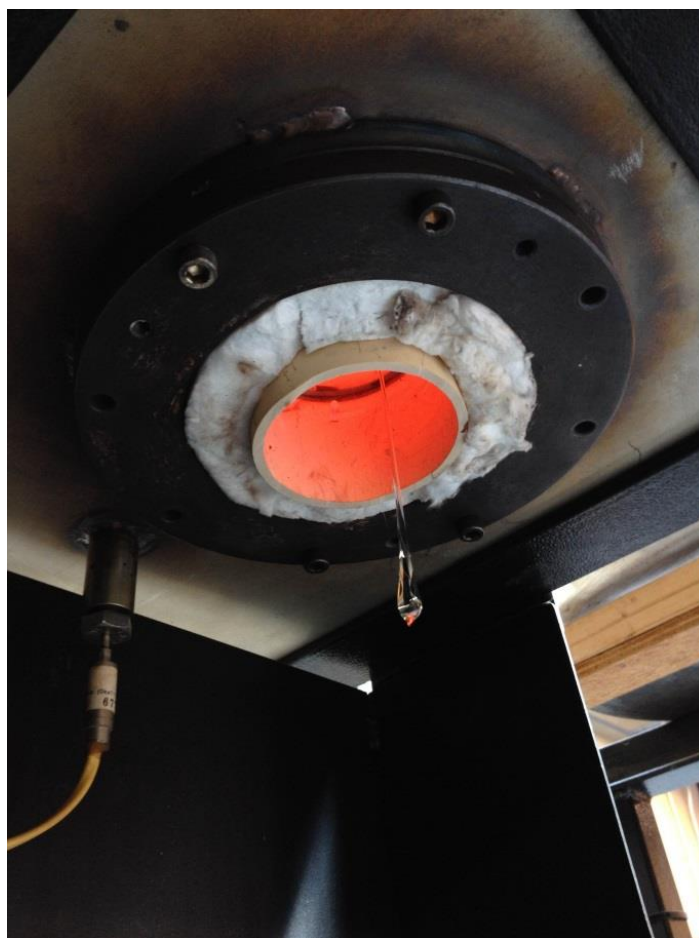
Figura 6.14 - Formação da gota de F18 durante seu processamento em fibras.
