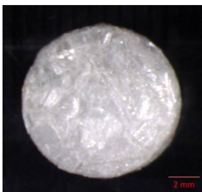
Figura 6.91 - Scaffold de 10 mm de diâmetro desenvolvido a partir de fibras de vidro do F18.
