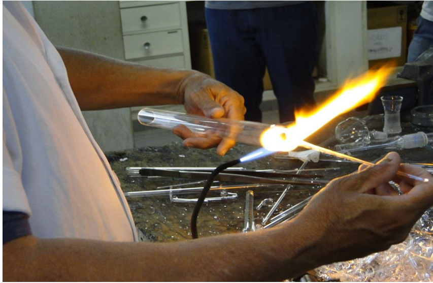
FIGURA 5.2 – Procedimento de fusão de uma proveta de vidro realizado durante a oficina de vidrarias no Departamento de Química – UFSCar.
