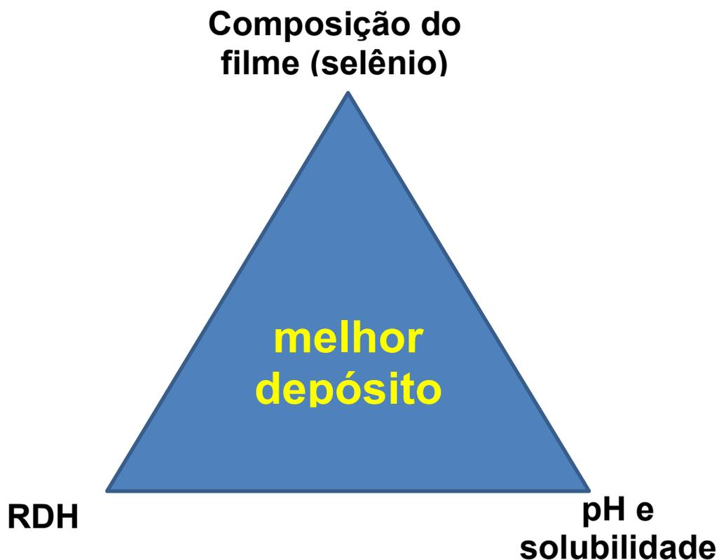
FIGURA 3.14 - Diagrama representativo dos principais fatores que influenciaram no controle das propriedades dos filmes a partir de um sistema ternário de Bi, Se e X (X = Cu, Fe ou Co). O controle dos fatores indicados nos vértices do triângulo deve fornecer o melhor resultado.
