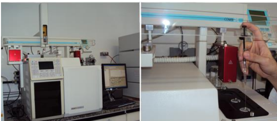
Figura 12. À esquerda, vista geral do cromatógrafo. À direita, detalhe da injeção da amostra gasosa com seringa.
