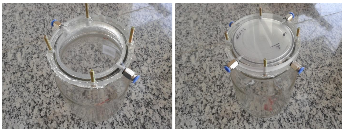
Figura 14. Vista superior das câmaras de permeação para avaliação da permeabilidade durante armazenagem de morango.
