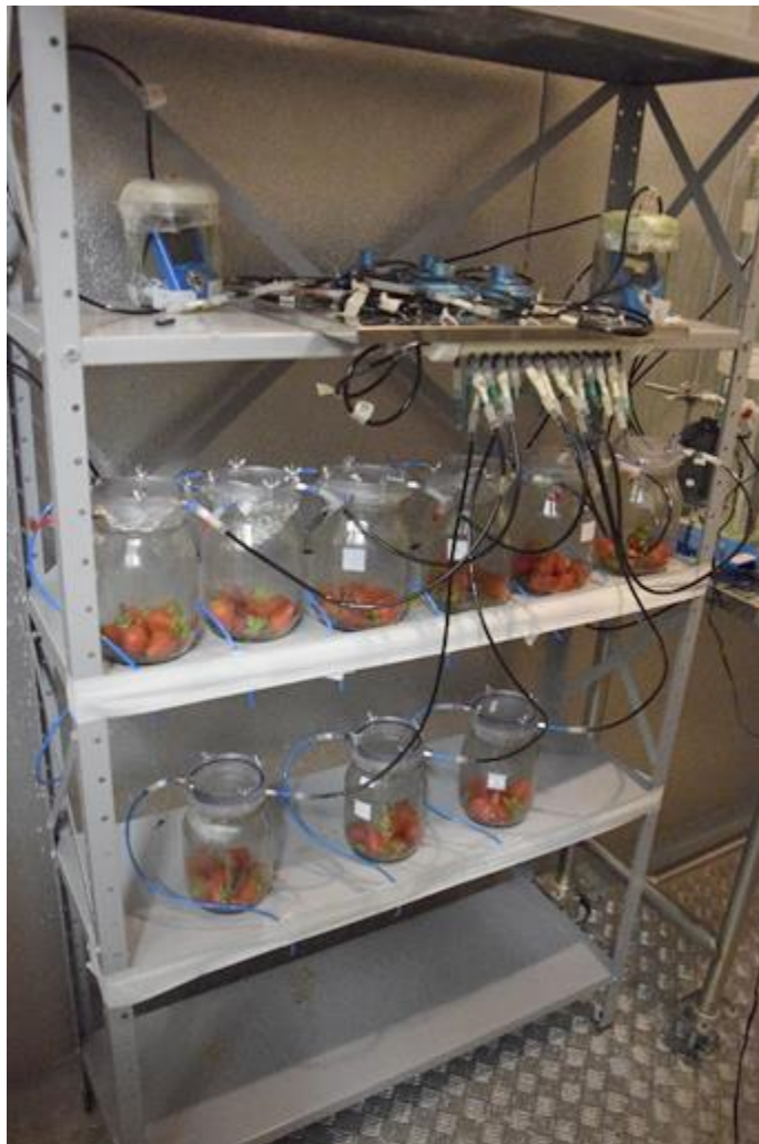
Figura 15. Disposição das câmaras de permeação utilizadas no interior da câmara fria.
