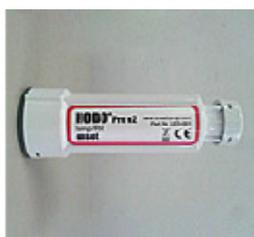
Sensor digital com data-logger
