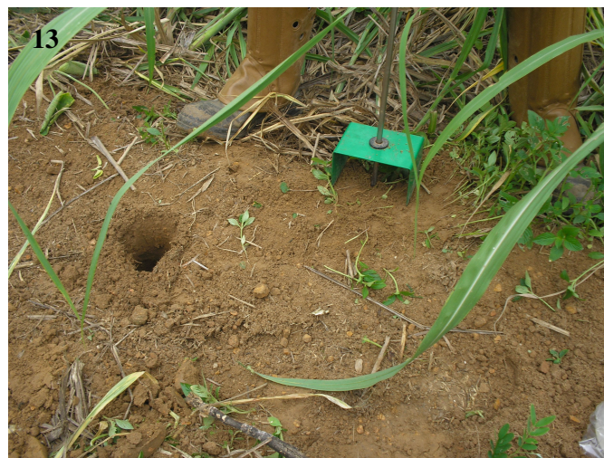
Figura 13. Avaliação da compactação do solo com penetrômetro eletrônico.
