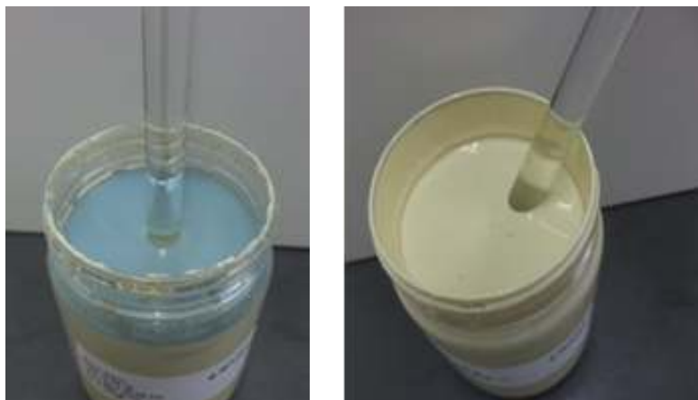
FIGURA 5.14 - Amostra Zinco Nano evidenciando falta de fluidez com característica “danete” (esquerda) e com a retomada fluidez após agitação (direita), apresentada no 2º e 3º meses de envelhecimento.
