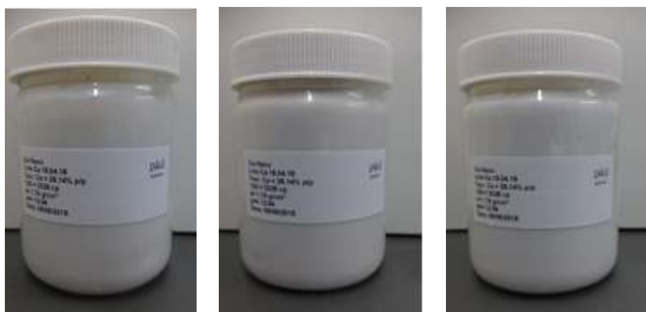
FIGURA 5.17 – Amostras de Cálcio Nano evidenciando a ausência de sinerese após 1º (esquerda), 2º (centro) e 3º (direita) meses de envelhecimento.
