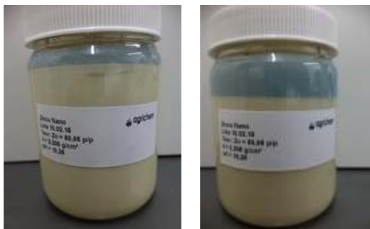
FIGURA 5.13 - Amostras de Zinco Nano evidenciando separação de fases com, respectivos, 1 e 1,8 cm de sobrenadante, após o 2º (esquerda) e 3º (direita) meses de envelhecimento.
