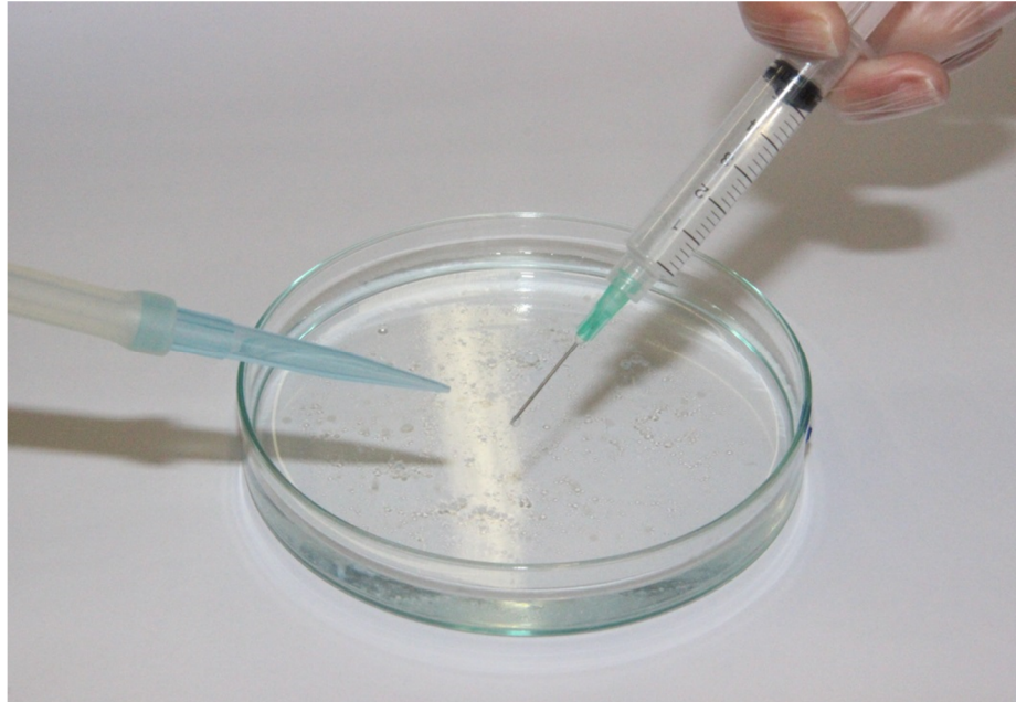
Figura 13 – Sistema para a formação das esferas de alginato de cálcio
