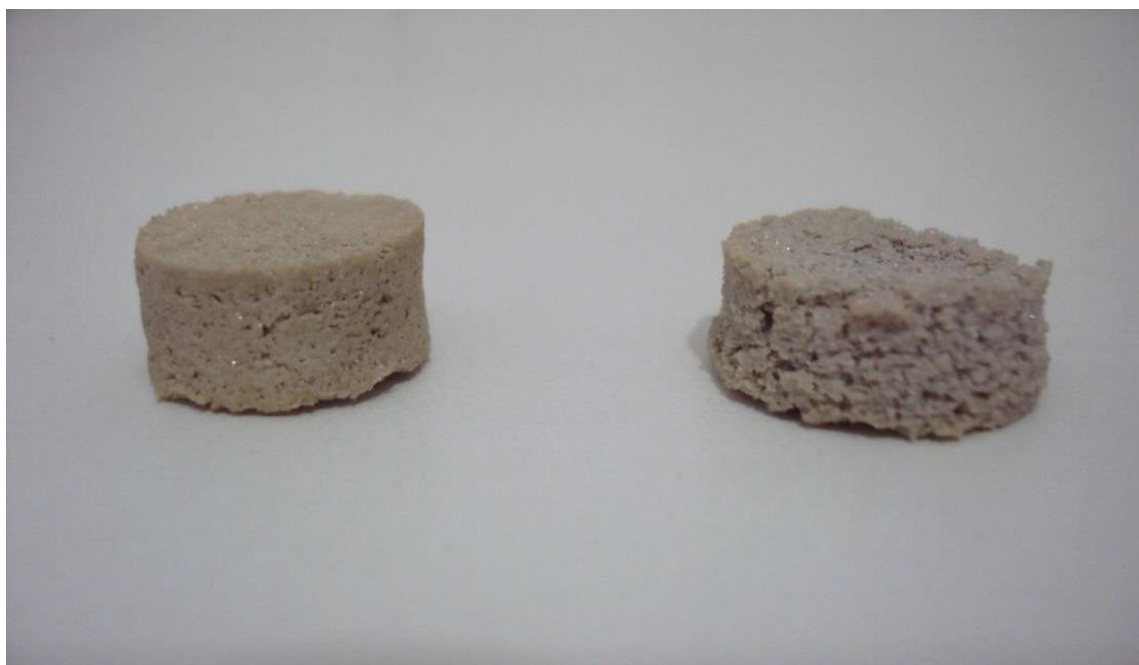
Figura 4.4 Pastilhas obtidas com o uso de 60% em volume de serragem de cambará (à esquerda) e polietileno (à direita).
