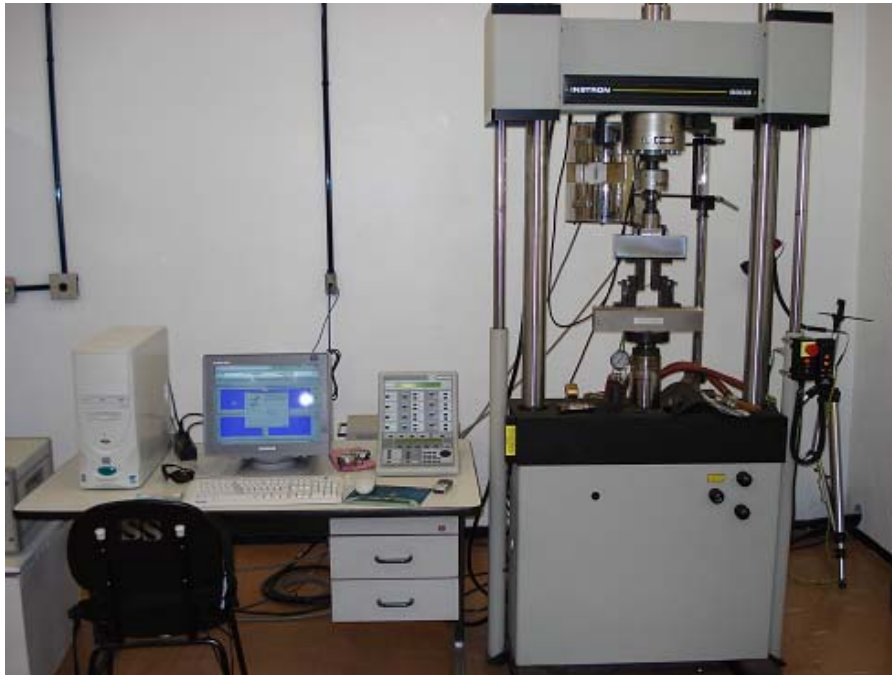
Figura 4. 7 - Foto da Máquina Universal Instrumentada de Ensaio Instron modelo 8802.
