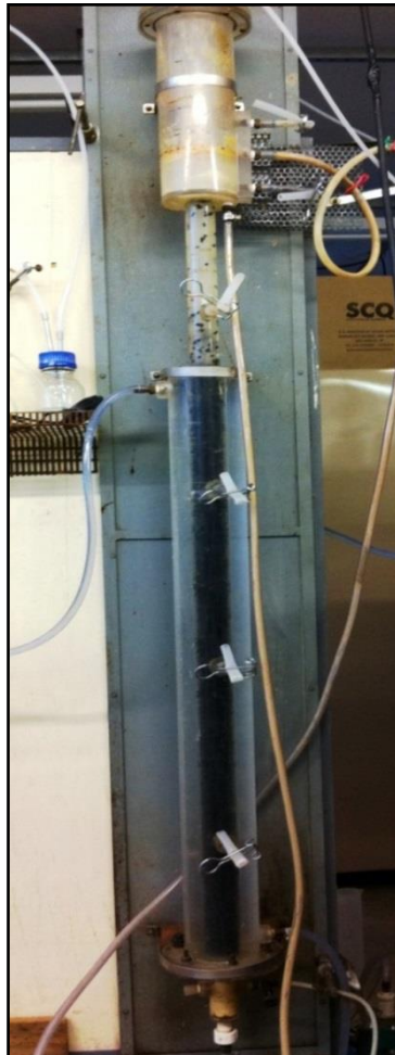
Figura 4-3: Reator anaeróbio de leito fluidizado mesofílico
