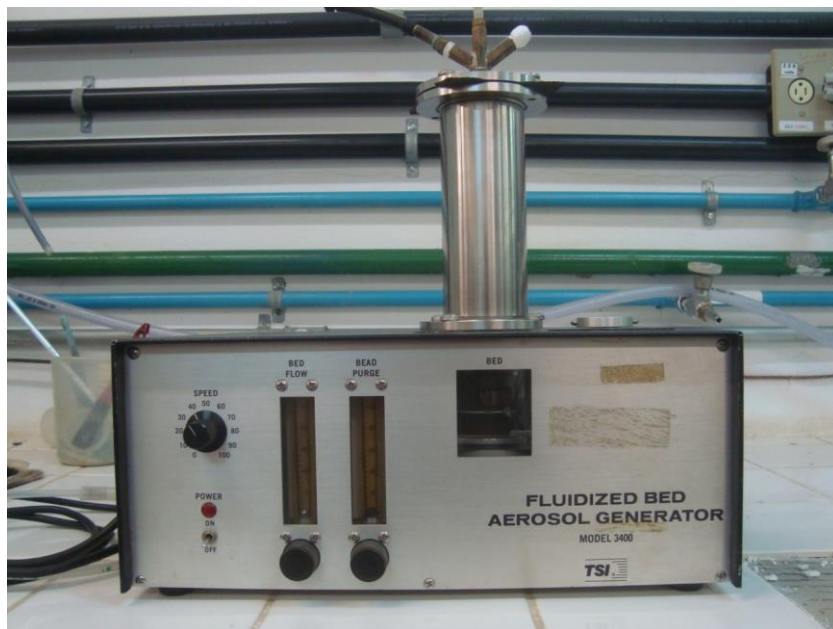
Figura 4.6: Gerador de leito fluidizado para a dispersão de partículas.
