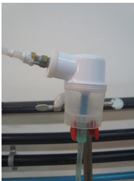
Figura 4.5: Inalador comercial para a geração de partículas.
