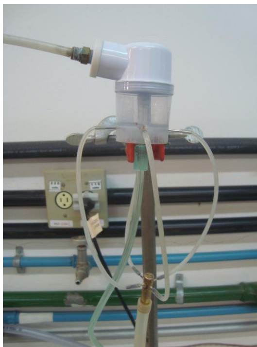
Figura 5.3: Inalador comercial adaptado com injeção de ar para a geração de partículas.
