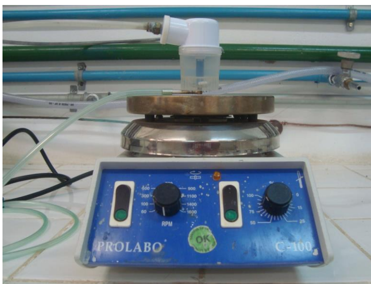
Figura 5.4: Inalador comercial adaptado com agitação magnética para a geração de partículas.
