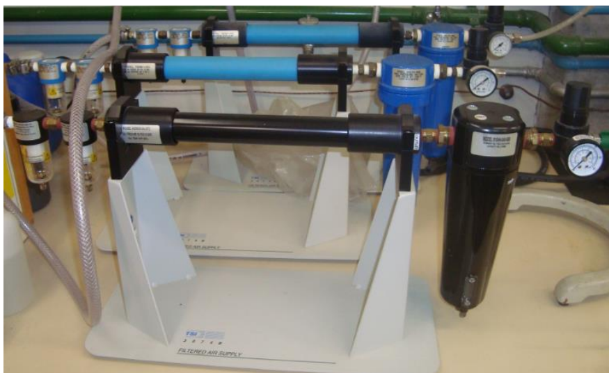
Figura 4.2: Dispositivo dos filtros de purificação de ar.
