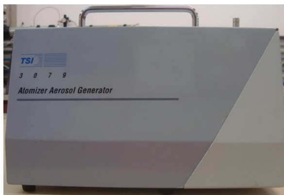
Figura 4.3: Gerador atomizador de aerossóis da TSI, modelo 3079.
