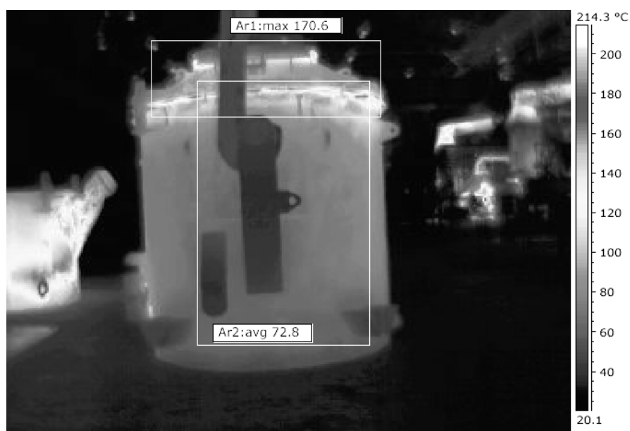
Figura 5.37: Termografia da face A do cadinho carregado com metal.
