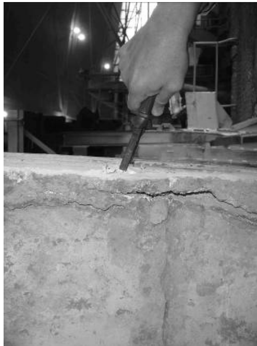
Figura 5.27: Infiltração de alumínio localizada no topo do cadinho. Visão lateral.
