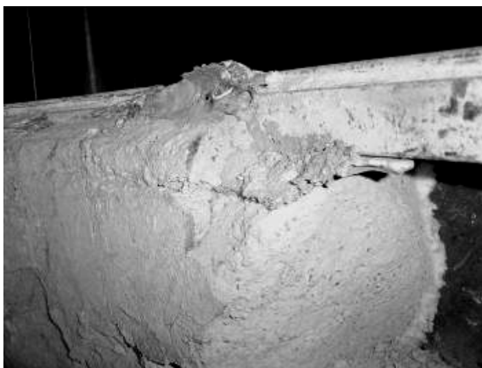
Figura 5.50: Alumínio infiltrado entre a carcaça metálica e o revestimento do topo do cadinho.
