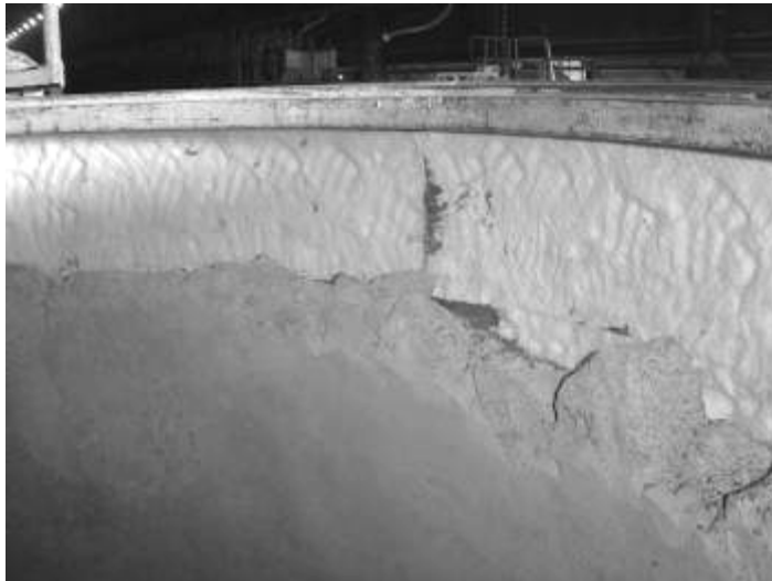
Figura 5.52: Carcaça metálica atacada pelo alumínio líquido.
