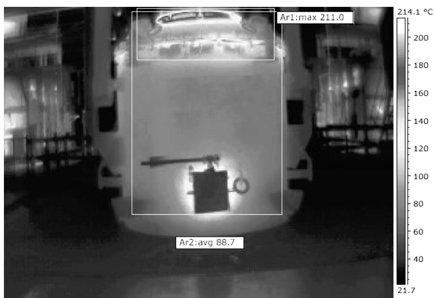
Figura 5.36: Termografia da face B do cadinho carregado com metal a 779°C (foto originalmente colorida).
