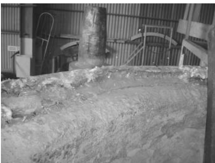
Figura 5.51: Carcaça metálica atacada pelo alumínio líquido.
