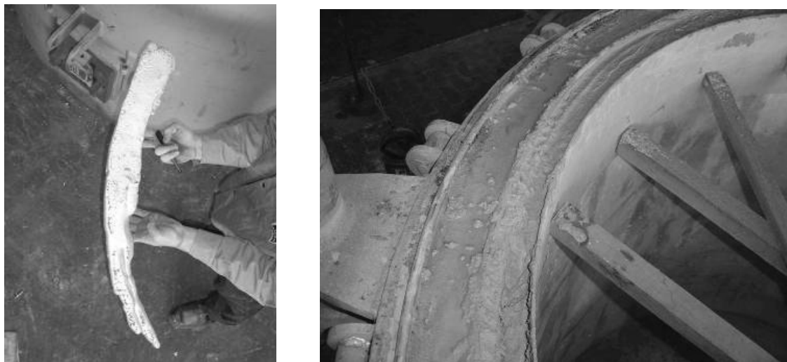
Figura 5.30: À esquerda: Porção de alumínio retirada. À direita: Topo do cadinho sofrendo reparo.
