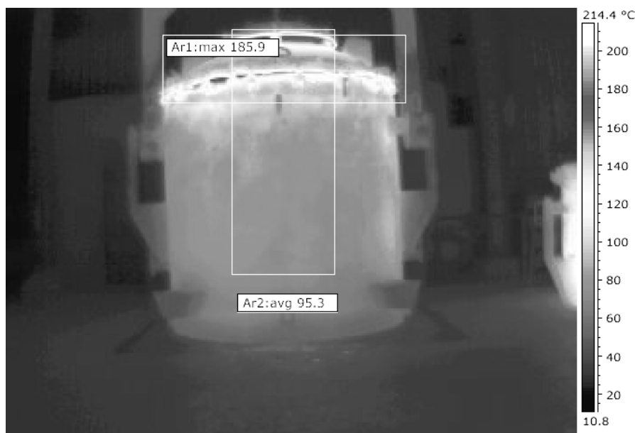
Figura 5.39: Termografia da face D do cadinho carregado com metal.
