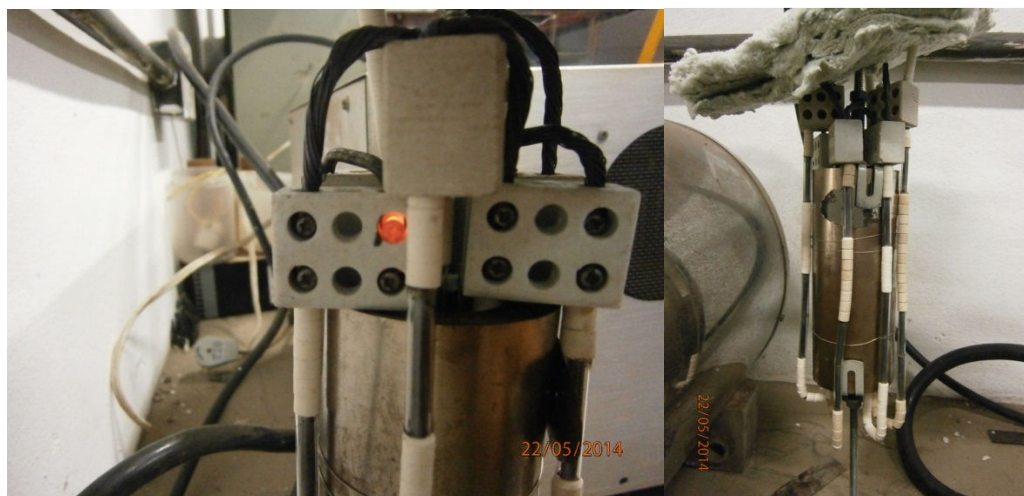
Figura A.5 Incandescência do parafuso na conexão da espira e resfriamento do conjunto sob um campo magnético estático externo calculado de 1276 A/m.
