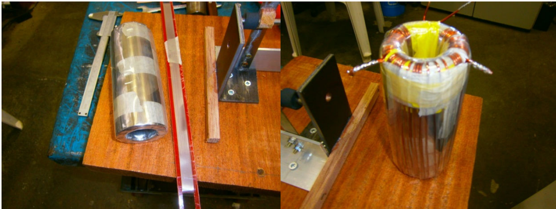
Figura 3.8 Núcleo toroidal, sem tratamento, envolto em fita de poliéster à esquerda, primário enrolado no núcleo à direita.
