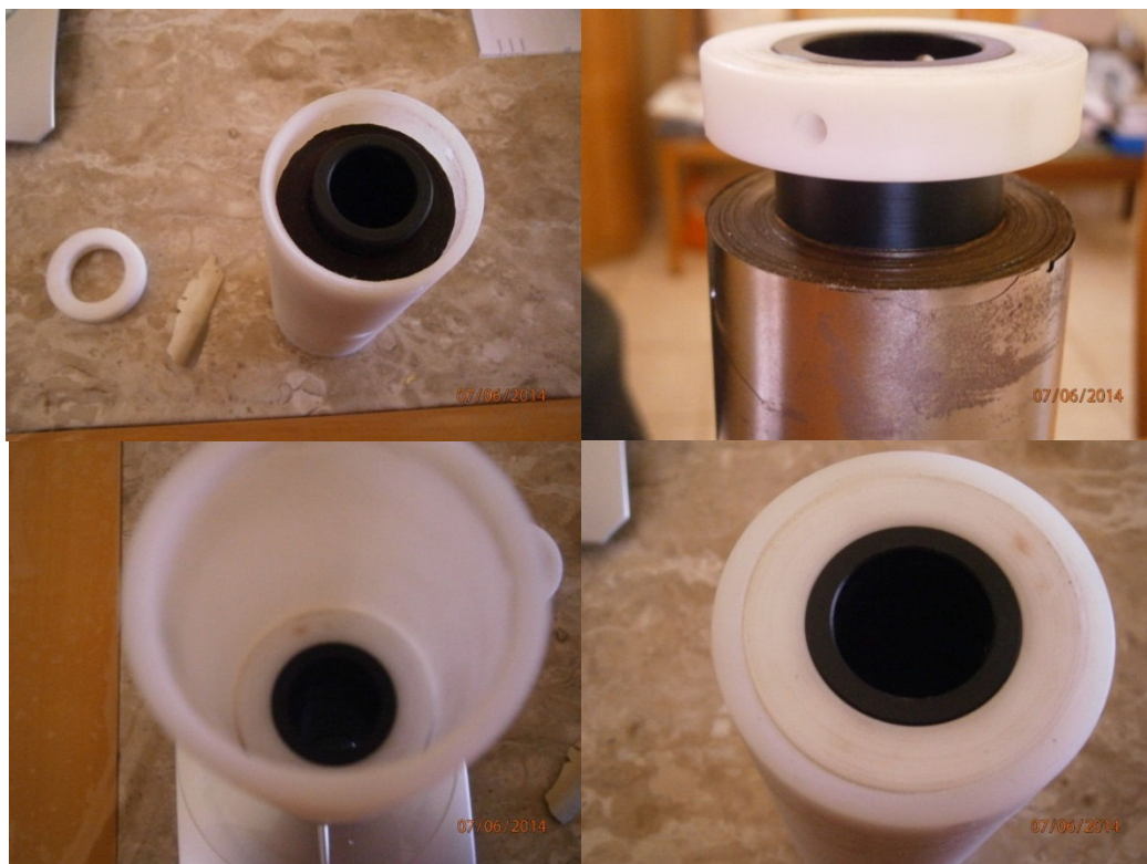
Figura 3.10 Algumas das etapas da montagem do invólucro no núcleo de liga amorfa.
