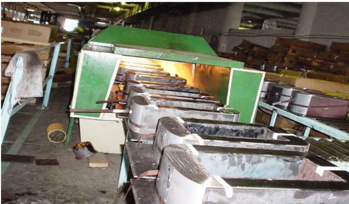
Figura 3.6 Tratamento termomagnético de núcleos de liga amorfa na Vijai conforme [33].
