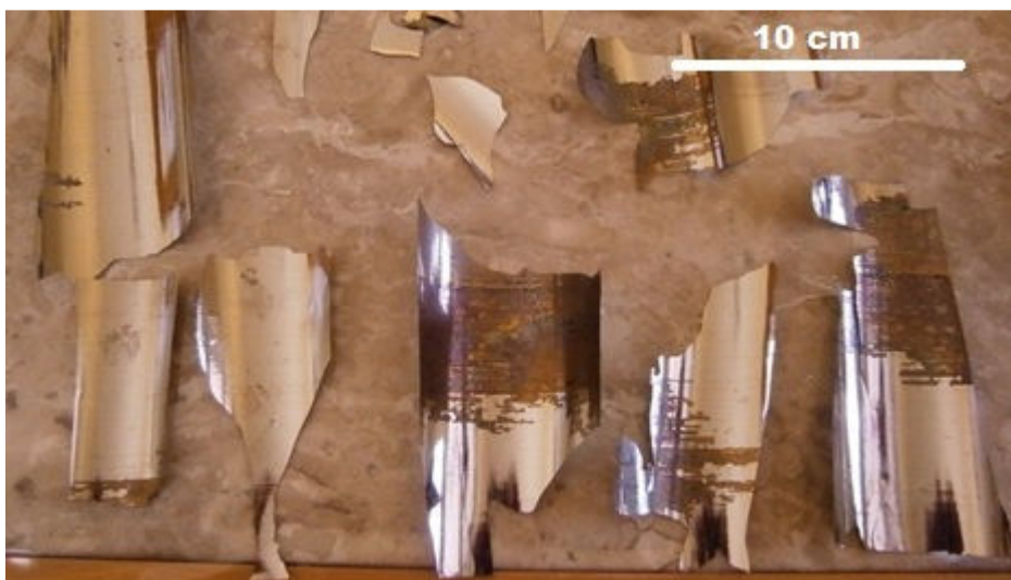
Figura 3.9 Fragmentos, de lâmina amorfa, decorrentes da manipulação do núcleo tratado termomagneticamente.
