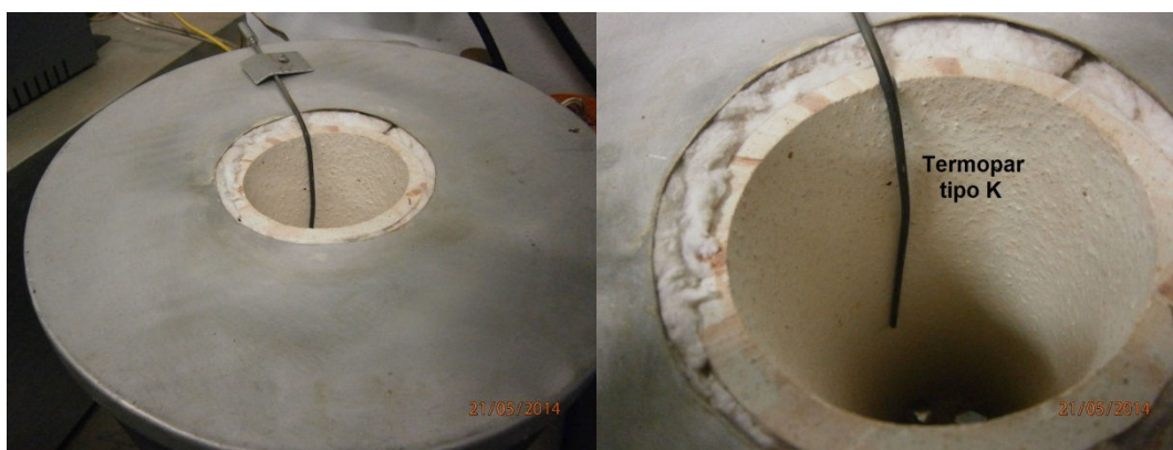
Figura A.1 Vista geral e detalhada do forno e do termopar utilizado.
