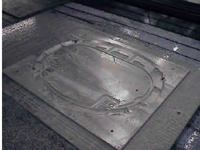
Figura 19 - Caverna do ERJ-170 durante a usinagem. [8]
