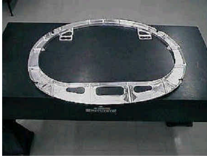
Figura 47 - Caverna do ERJ-170 após a usinagem.
