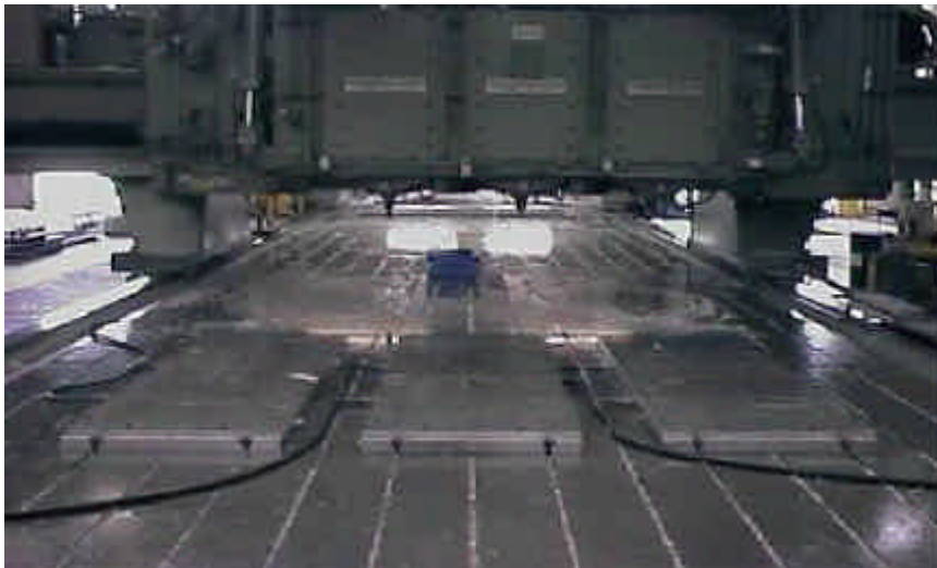
Figura 18 - Disposição das placas durante a usinagem na máquina Gantry. [8]
