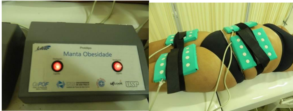
Figura 5 e 6. Imagem da Manta para Obesidade: Figura 5 – caixa de controle; Figura 6 – disposição das placas na região anterior.
