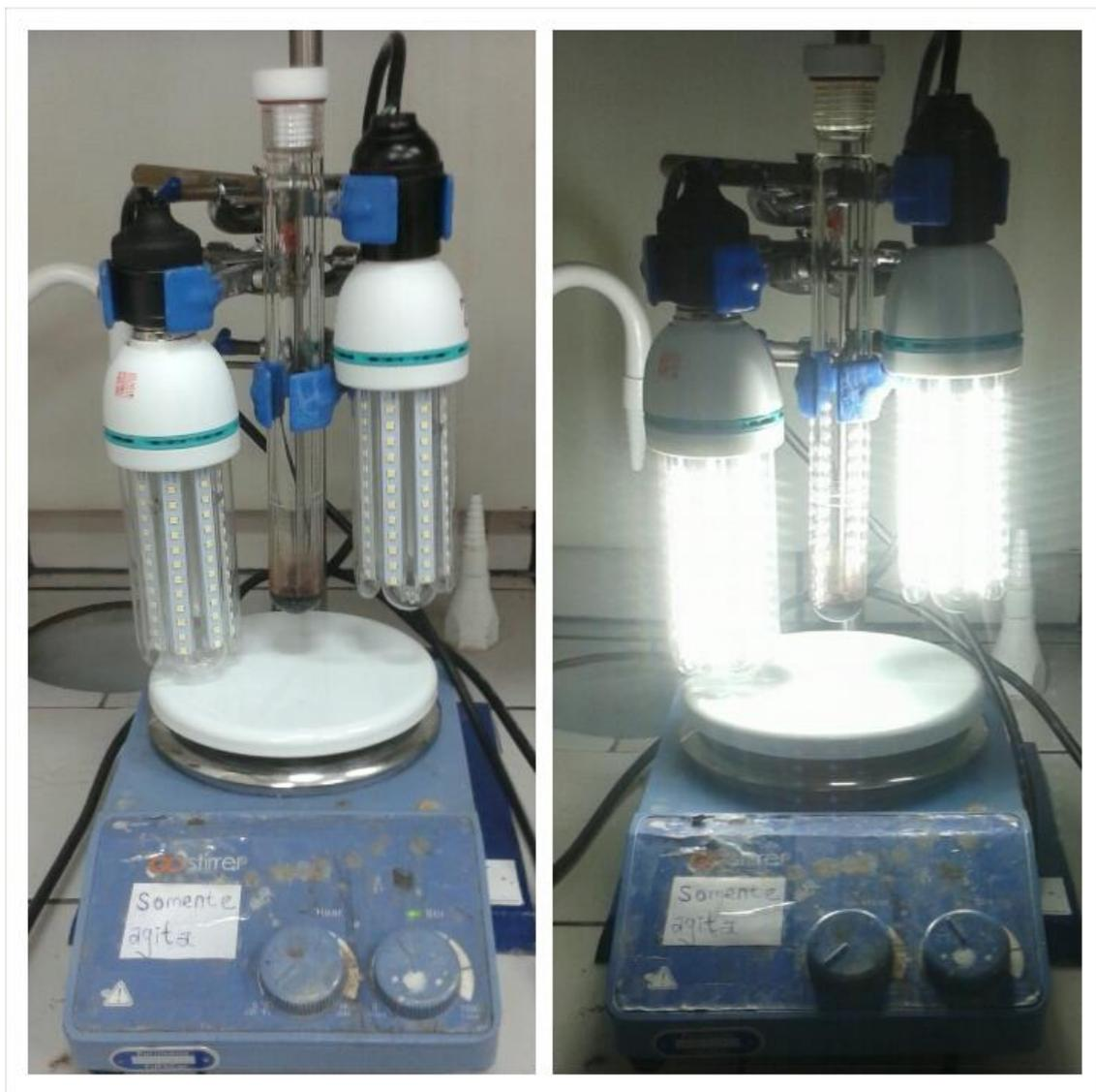
**FIGURA 40:** Foto tirada do sistema montado com lâmpada de LED na tentativa de obtenção do composto **98**.
