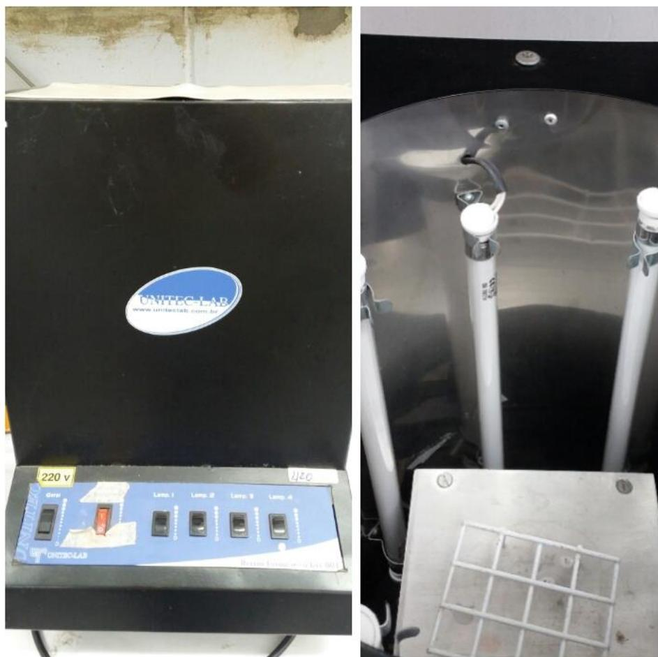
**FIGURA 39:** Reator fotoquímico utilizado na tentativa de obtenção do composto **98** com irradiação abaixo de 420 nm.
