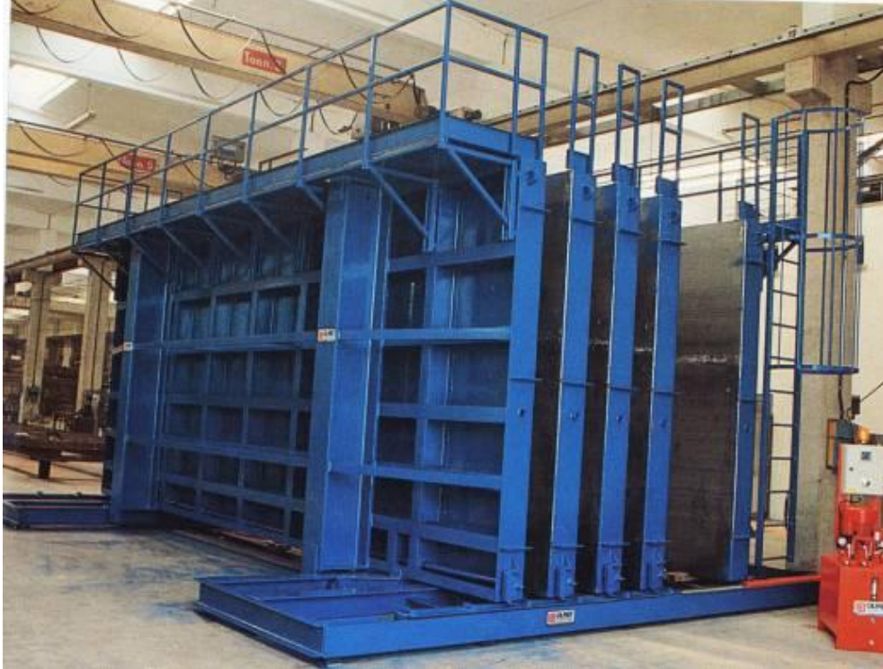
Figura 3.3: Forma vertical – tipo bateria.
