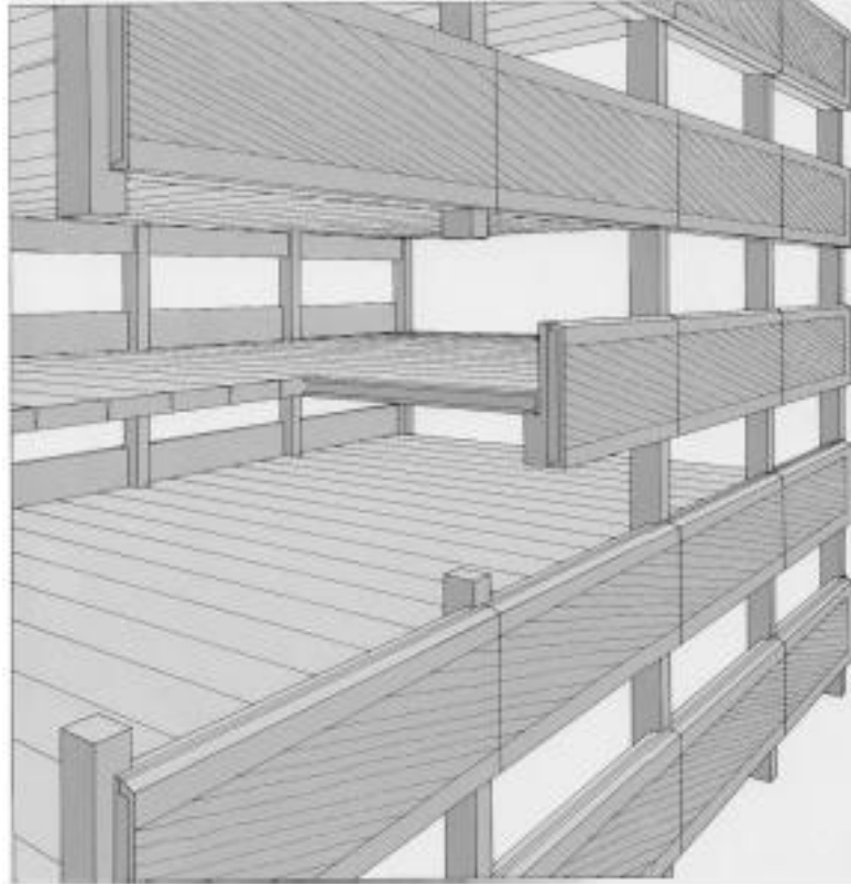
Figura 2.14: Viga peitoril em fachadas atuando como elementos estruturais.
