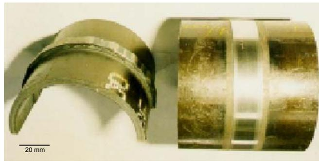
Figura 3.11 Aspecto característico de uma junta soldada pelo processo de soldagem por fricção radial - SFR [21].
