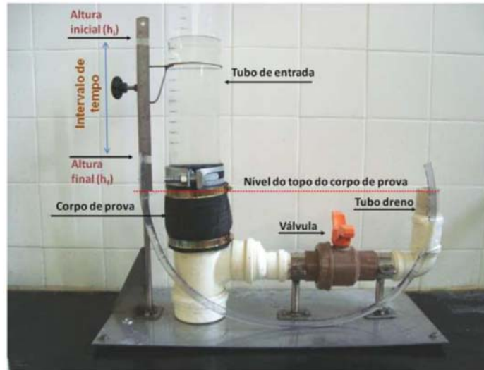
Figura 15 - Permeâmetro utilizado para os ensaios de permeabilidade para pisos porosos ou drenantes do fabricante 1.
