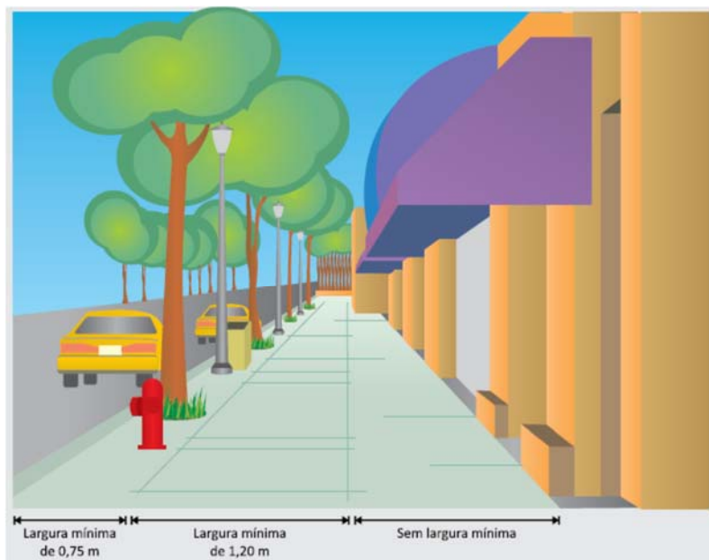
Figura 13: Esquema ilustrativo de padronização de calçadas
