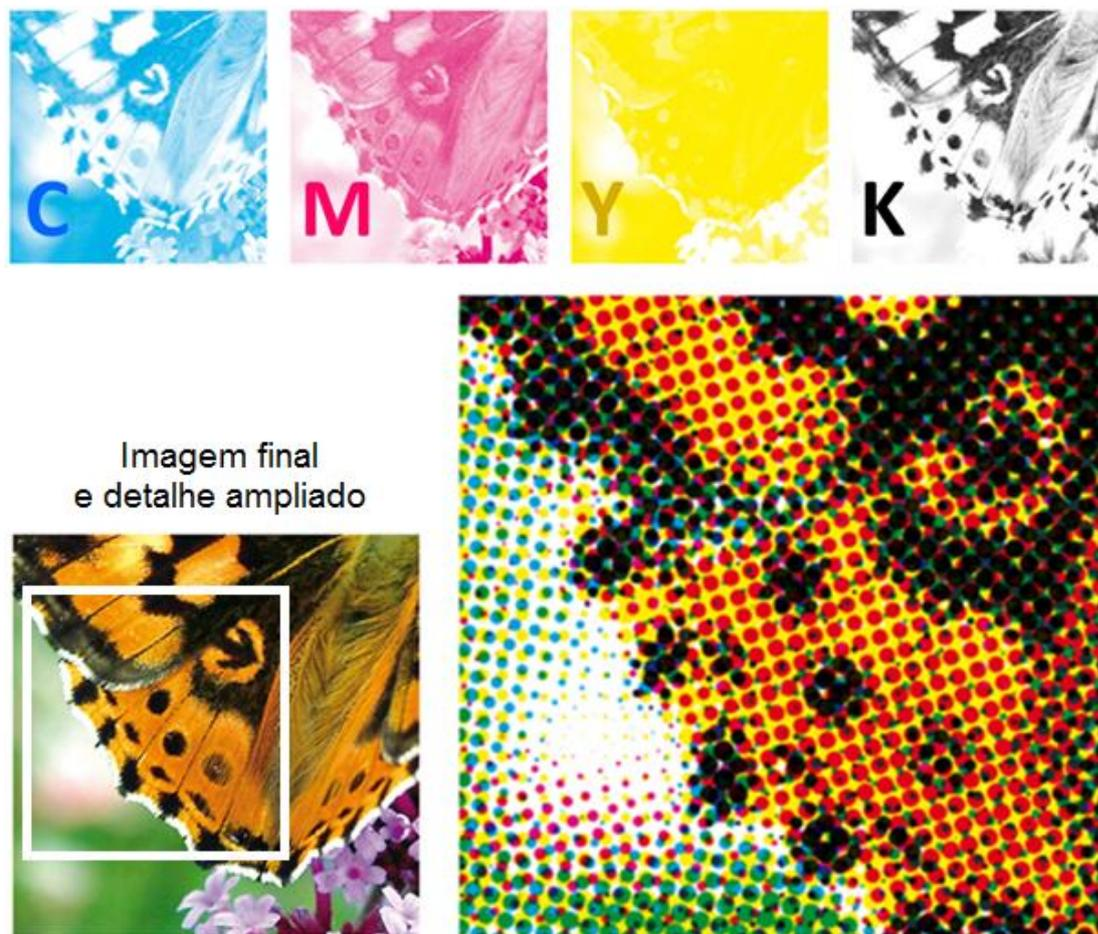
Figura 2.5 Formação de imagem na impressão digital através da combinação de camadas de pontos das quatro cores do modelo CMYK [39]
