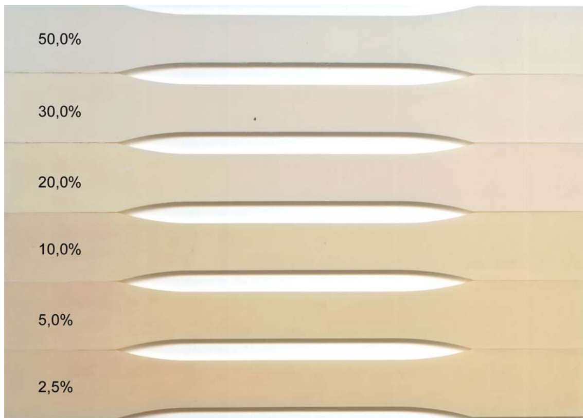
Figura E.1 – Aparência dos corpos de prova injetados da blenda ABS H300L/SAN Nitriflex com as diferentes quantidades de SAN incorporadas.
