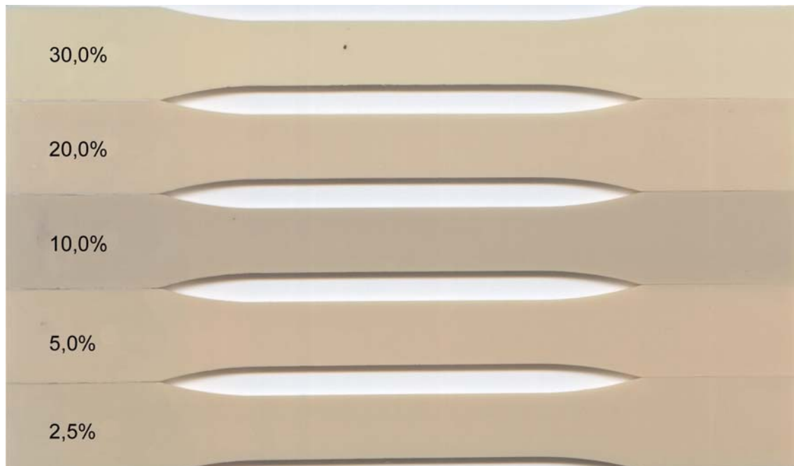
Figura E.2 - Aparência dos corpos de prova injetados da blenda ABS 870/ SAN Nitriflex com as diferentes quantidades de SAN incorporadas.
