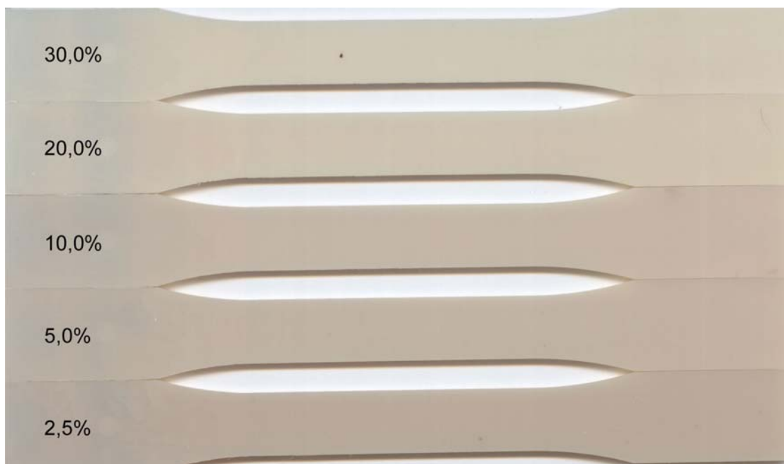
Figura E.3 - Aparência dos corpos de prova injetados da blenda ABS Cicolac ® / SAN Nitriflex com as diferentes quantidades de SAN incorporadas.
